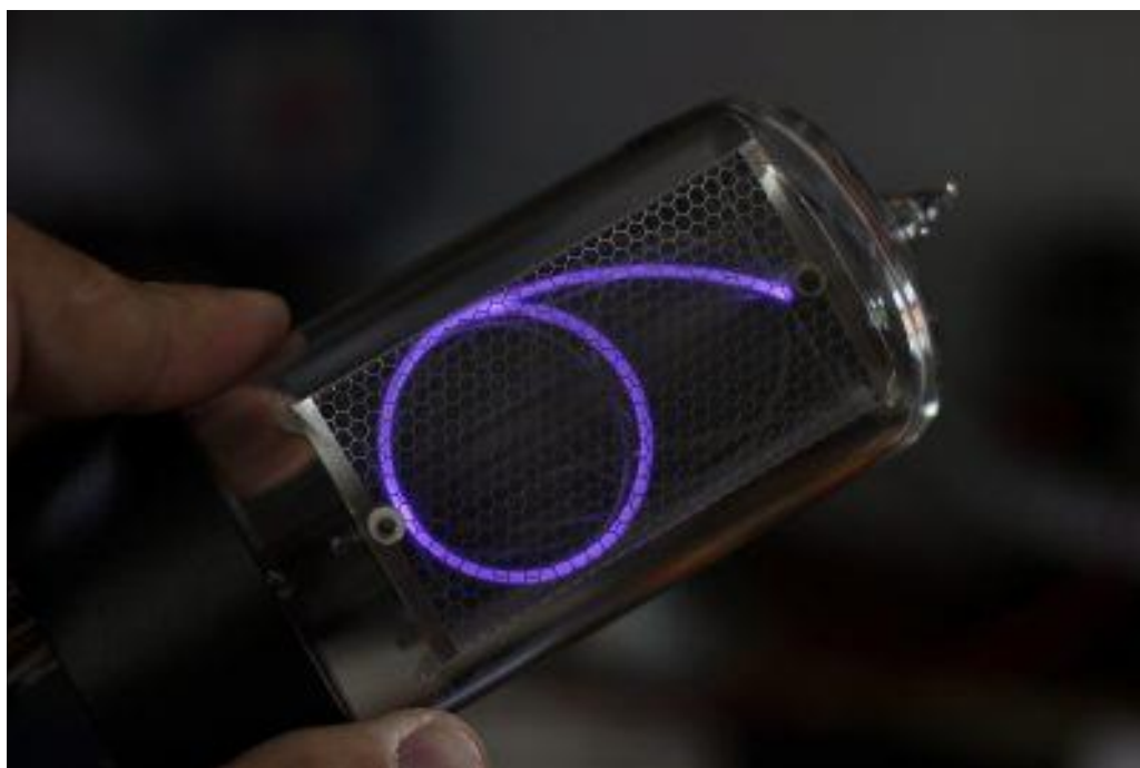
Obrázek 1.5 Fialový výboj digitronu plněného argonem [4]
