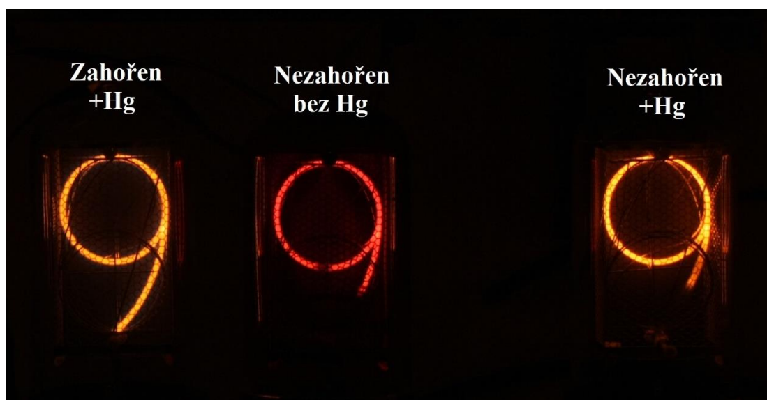
Obrázek 1.9 Digitrony před a po zahoření
