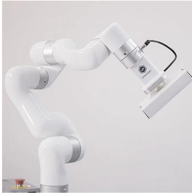
Obrázek 5.5 Rameno UFactory xArm s vakuovým uchopovačem [7]
