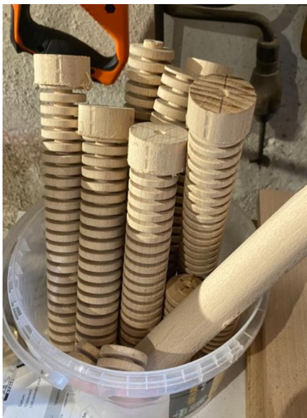
Obrázek 27: Mezikrok výroby před oddělením jednotlivých koleček přímočarou pilou (Zdroj: Vlastní zpracování)
