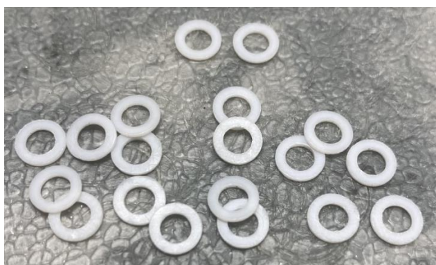
Obrázek 37: První verze podložky z teflonu (Zdroj: Vlastní zpracování)
