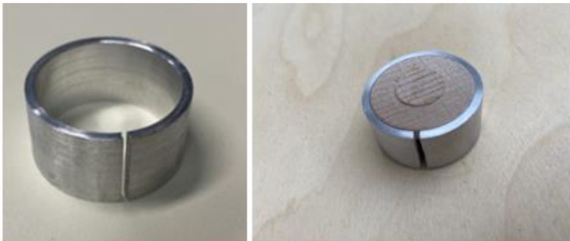
Obrázek 34: Přípravek pro zbrúšení hran koleček (Zdroj: Vlastní zpracování)
