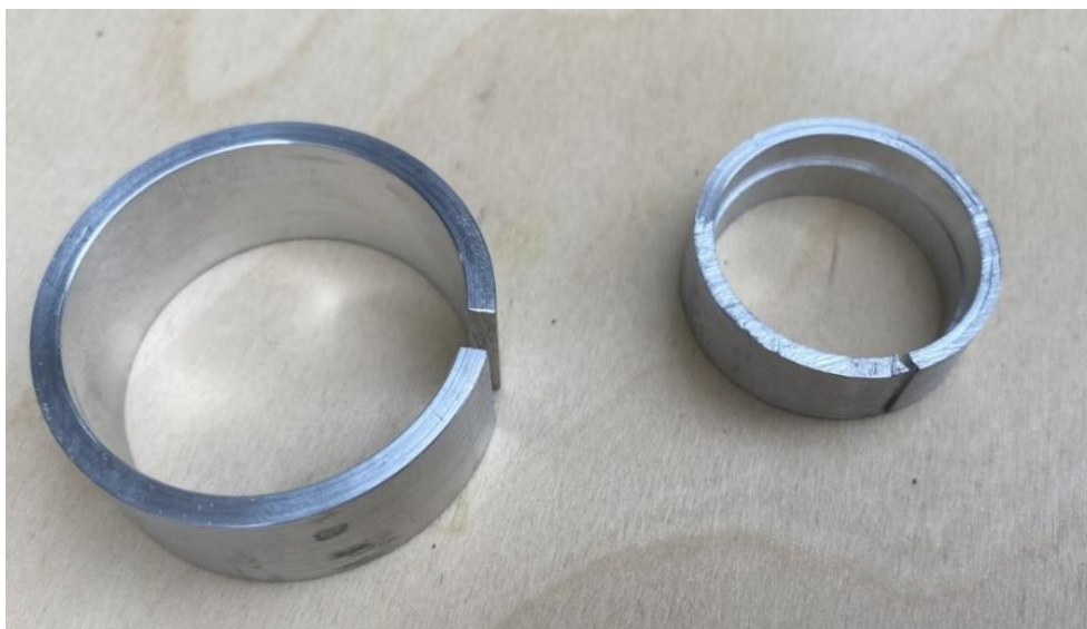
Obrázek 33: Přípravek pro zbroušení hran válce lokomotivy a cisterny (Zdroj: Vlastní zpracování)
