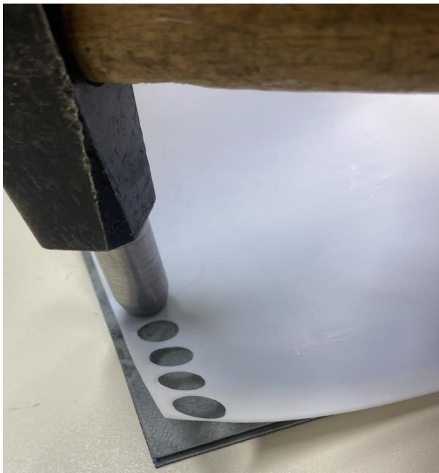
Obrázek 40: Postup děrování teflonu (Zdroj: Vlastní zpracování)
