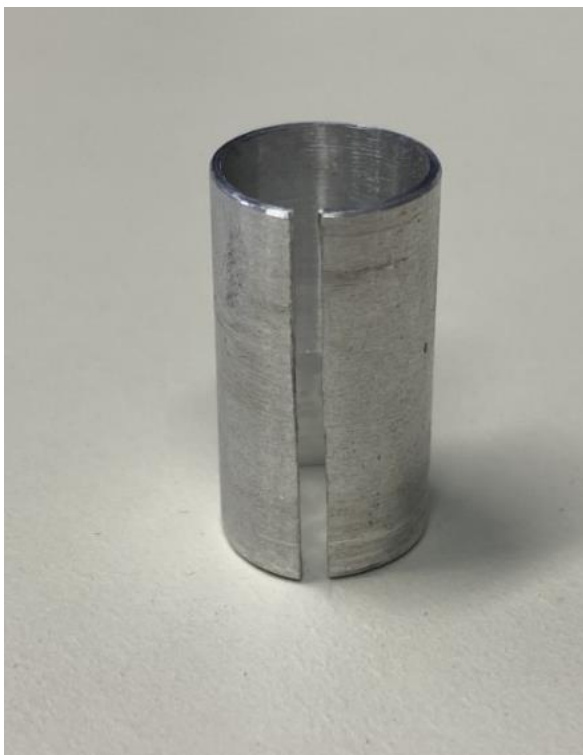
Obrázek 35: Přípravek pro zbrúšení hran sloupků ohrádkového vagonu (Zdroj: Vlastní zpracování)
