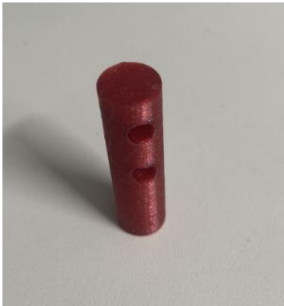
Obrázek 46: Sloupek ohrádkového vagónu vyrobený pomocí 3D tisku (Zdroj: Vlastní zpracování)
