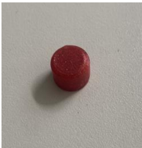
Obrázek 47: Ventil cisterny vyrobený pomocí 3D tisku (Zdroj: Vlastní zpracování)
