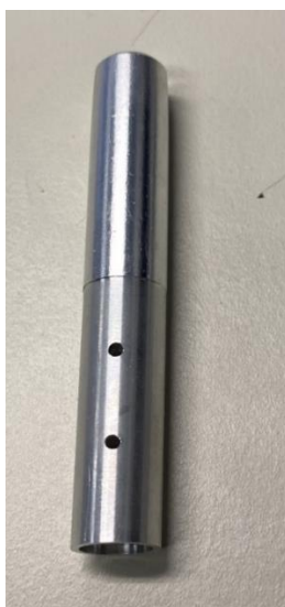
Obrázek 29: Přípravek pro vrtání děr do sloupků ohrádky (Zdroj: Vlastní zpracování)
