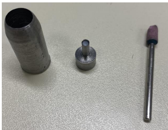
Obrázek 39: Děrovací přípravek na teflon (Zdroj: Vlastní zpracování)
