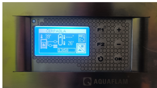
(b) Zobrazení čerpadel a teploty bojleru
