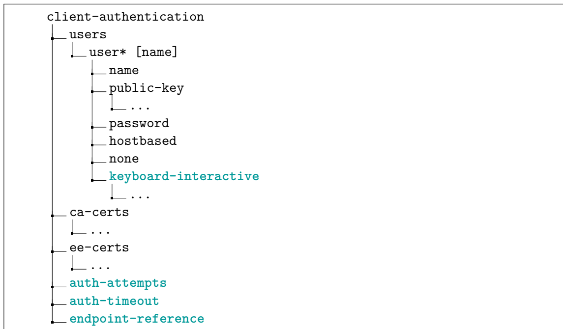
Diagram 5.3: Struktura rozšířeného kontejneru client-authentication pro podstrom ssh . Uzly rozšiřující původní popis jsou barevně a tučně zvýrazněny.
