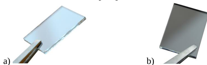
Obr. 55: Skleněný substrát: a) s vrstvou \text{SiO}_2 , b) s FTO
