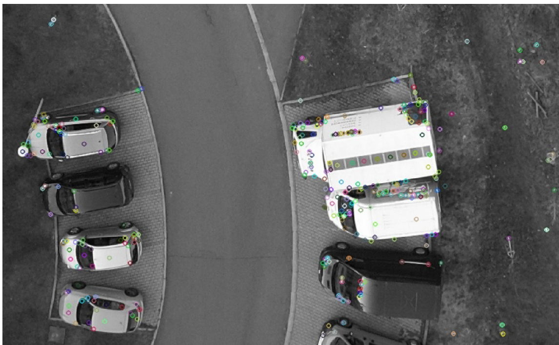
Obrázek 2.9: Výstřižek ze snímku, kde byly nalezené obrazové příznaky pomocí algoritmu SIFT vyznačeny barevnými kolečky.
