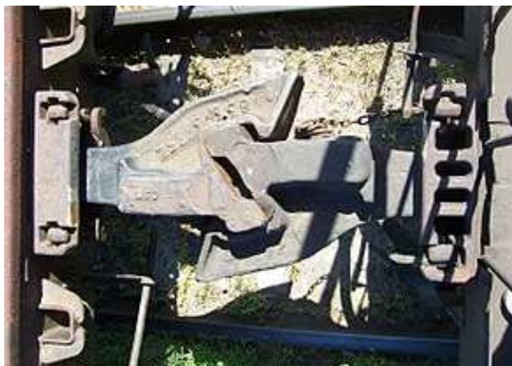
Obrázek 10 - Automatické spřáhlo SA3, zdroj: cs.wikipedia.org
