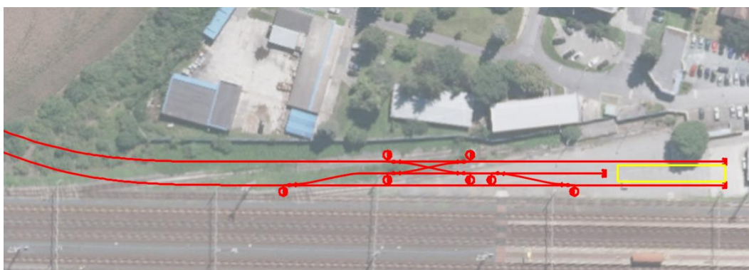
Obrázek 27 – Manipulační kolej v prostoru mezi hlavními kolejemi
