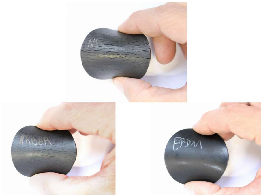
Obr. 53 Demonstrace rozdílu materiálu Cellentic® při stlačení oproti pryži. [57, 84]
