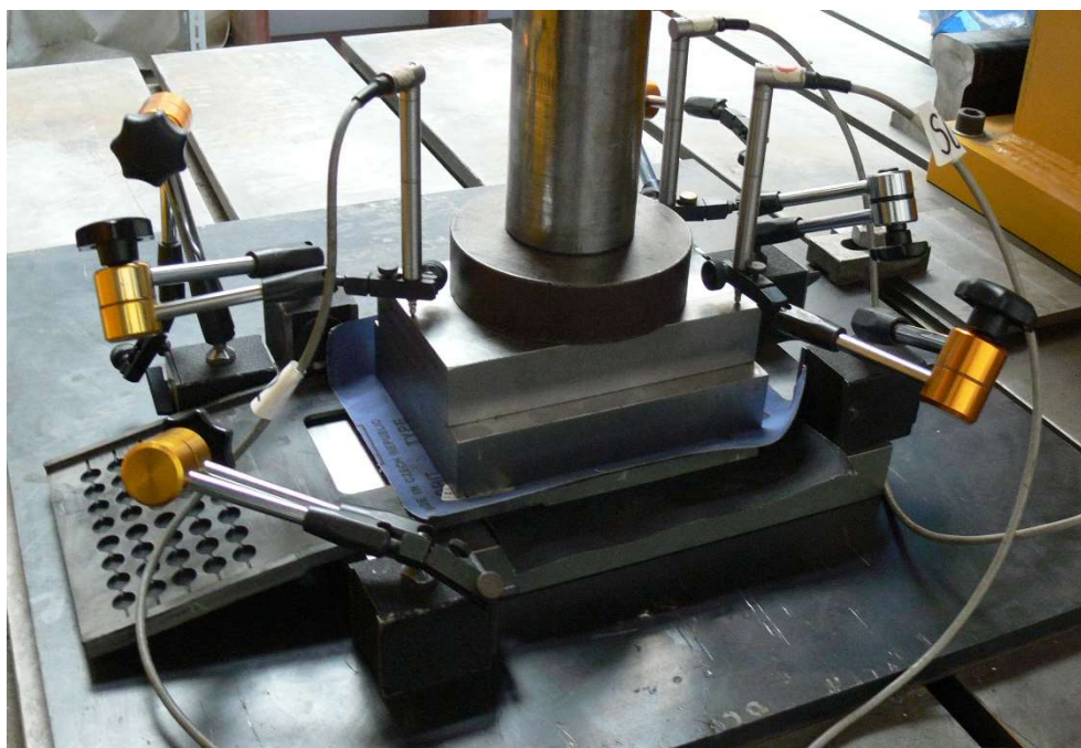
Obr. 158 Sestava laboratorní zkoušky tuhosti nové podložky Renogum.
