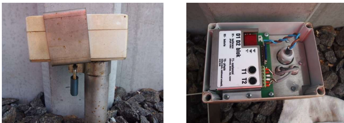
Obr. 74 Elektronická část zařízení TON 1 – boční pohled a pohled na elektronickou jednotku.
