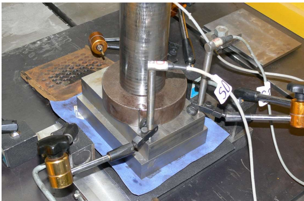
Obr. 161 Sestava lab. zkoušky tuhosti užitá podložky KSN Renogum.
