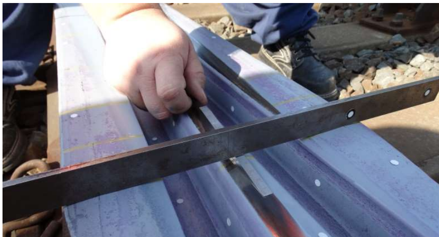
Obr. 71 Měření ojetí srdcovky klínkem a pravítkem.
