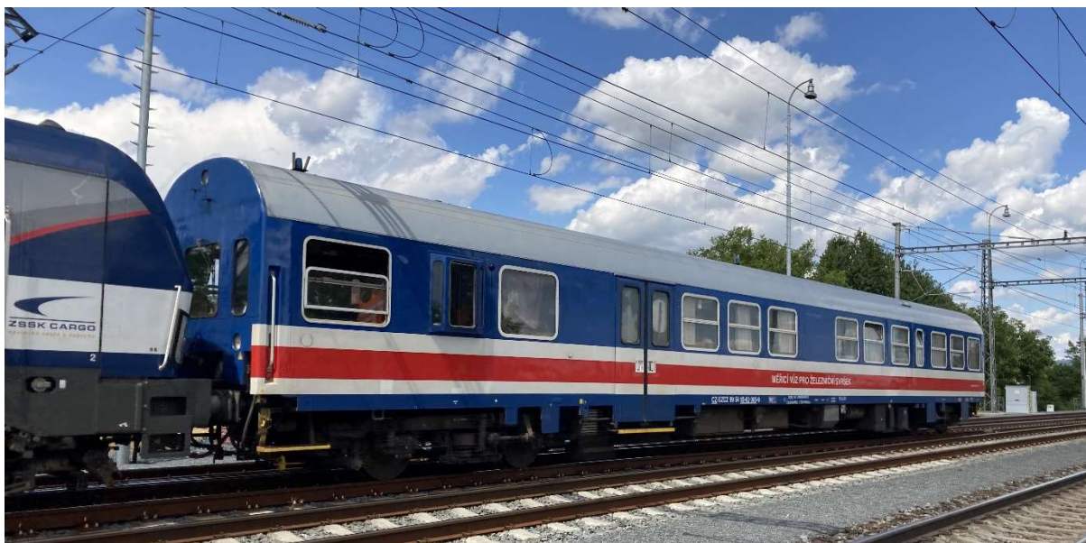
Obr. 92 Ilustrativní obrázek měřicího vozu železničního svršku při průjezdu žst. Prosenice.
