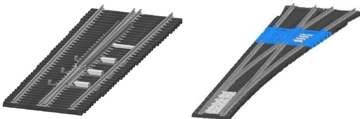
Obr. 12 Zhotovený 3D model srdcovkové části výhybky J60-1:33,5-8000/4000/14000-PHS v sw. Autodesk Inventor včetně přestavných a závěrových systémů DTZ a snímače rozřezu [62]
