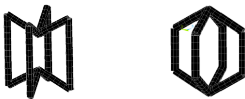
Obrázek 77: Jedna buňka analyzované mikroprutové struktury typu a) AUX-3D, b) KONV-3D.
