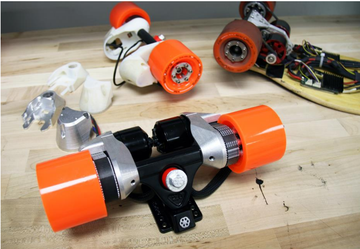
Obr. 14 – Hnací ústrojí 1. generace Boosted Boardu [13]
