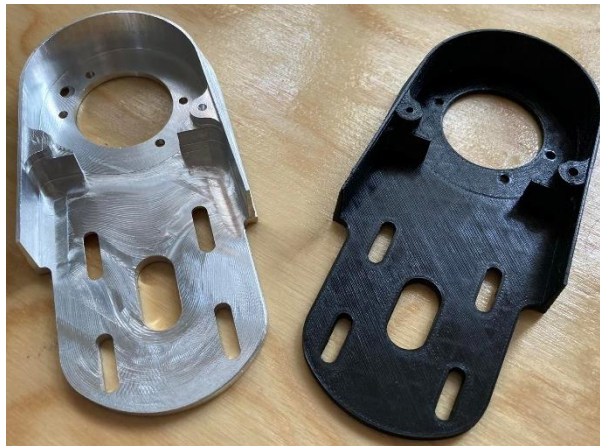
Obr. 63 – Nalevo prototyp držáku vytištěný FDM tiskárnou, nalevo funkční výrobek vyrobený CNC frézováním.
