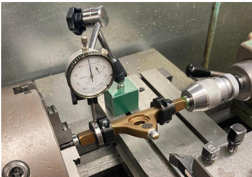
Obr. 64 – Měření obvodového házení unašeče s nasazeným ložiskem
