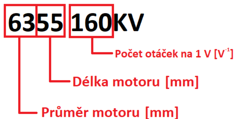
Obr. 46 – Příklad značení BLDC elektromotoru 6355 160KV
