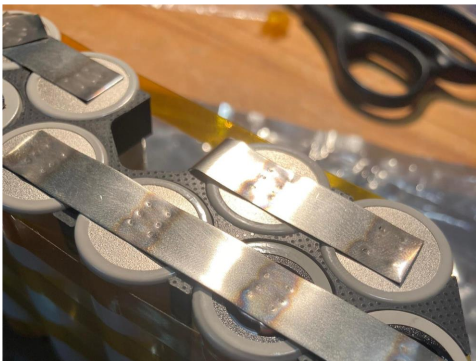
Obr. 37 Ukázka spojení bodovým svařováním článků pomocí niklových pásků
