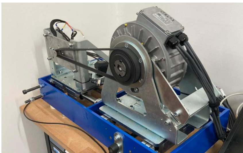
Obr. 53 – Stand pro brždění elektromotorů, nalevo měřený motor, napravo generátor.
