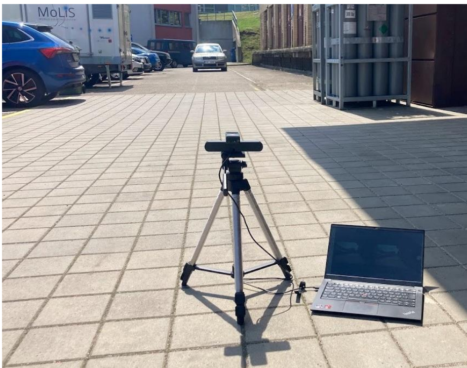
Obr. 40 Konfigurace měření pro ověření přesnosti určení vzdálenosti kamerou
