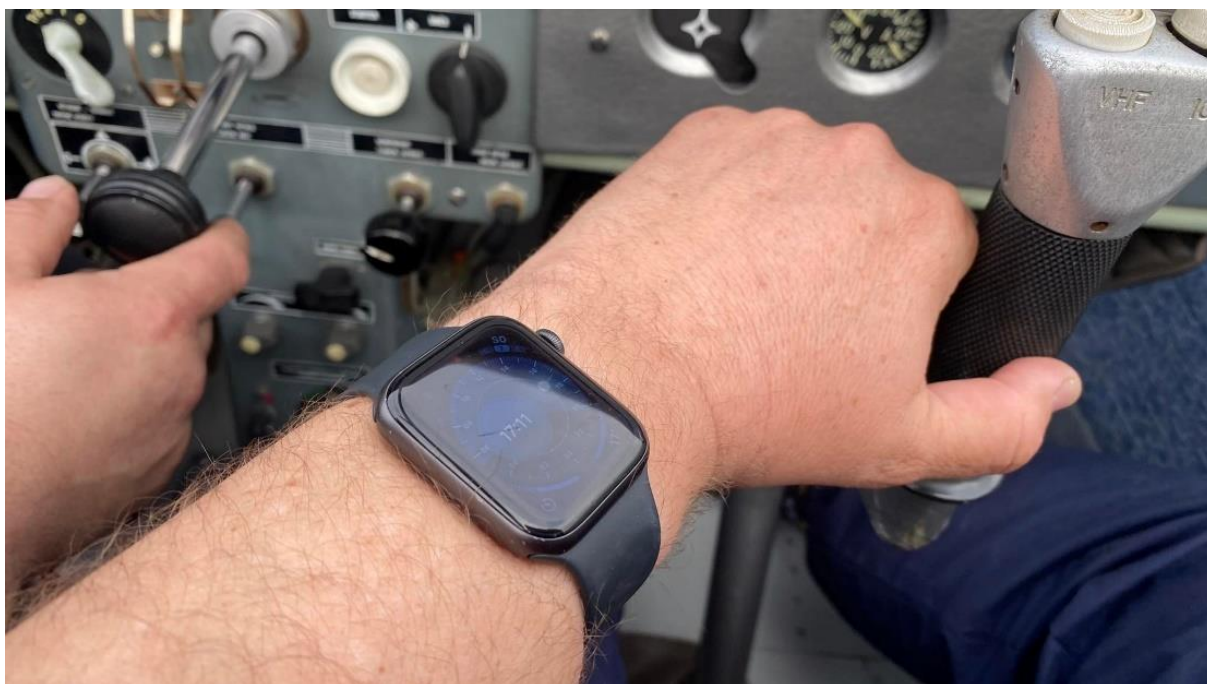
Obrázek 5: Správné umístění a utažení hodinek je důležité pro získání přesných hodnot srdeční frekvence, zdroj: autorka
