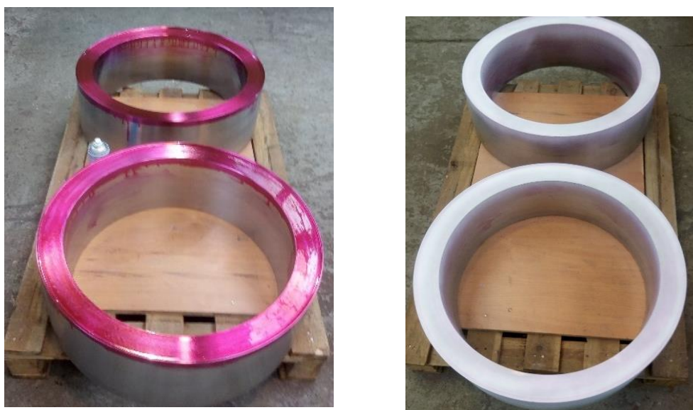
Obr. 49 Penetrační kontrola návarových hran.
