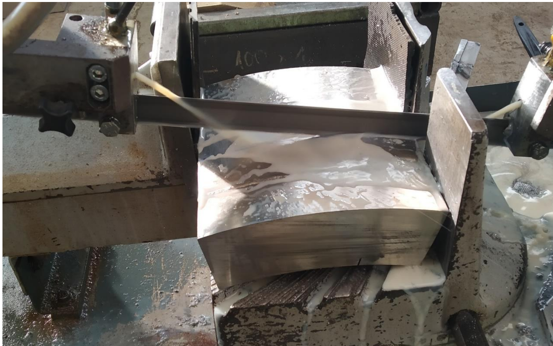
Obr. 57 Dělení vzorků pro destruktivní zkoušky.
