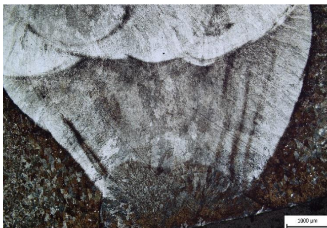
Obr. 73 Snímek v oblasti kořenové vrstvy.
