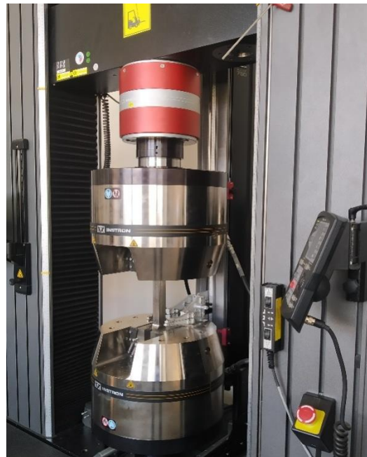
Obr. 59 Zařízení pro tahovou zkoušku.
