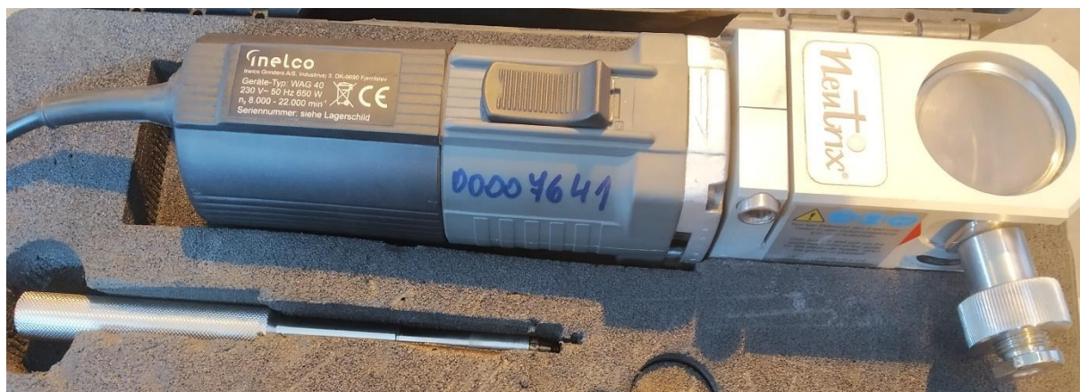
Obr. 45 Bruska na broušení wolframových elektrod.
