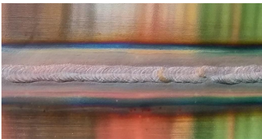
Obr. 55 Kořenová vrstva spoje.
