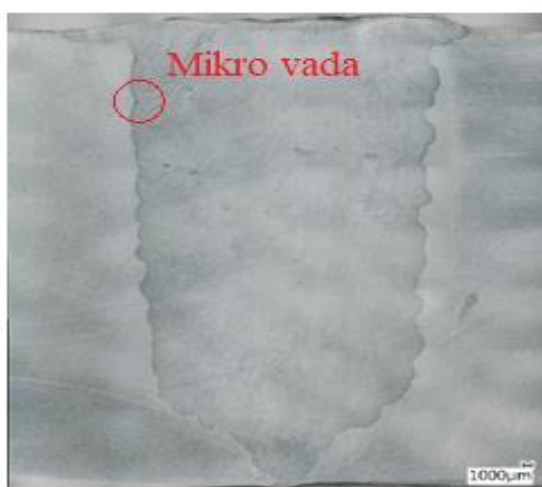
Obr. 67 Svarový spoj po naleptání.
