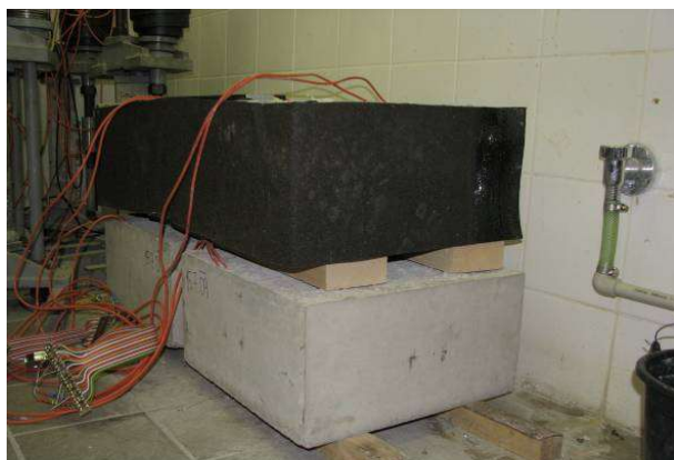
Obr. 4: Těles v klimatizované laboratoři, horní tělesa s izolací, převzato z [18]
