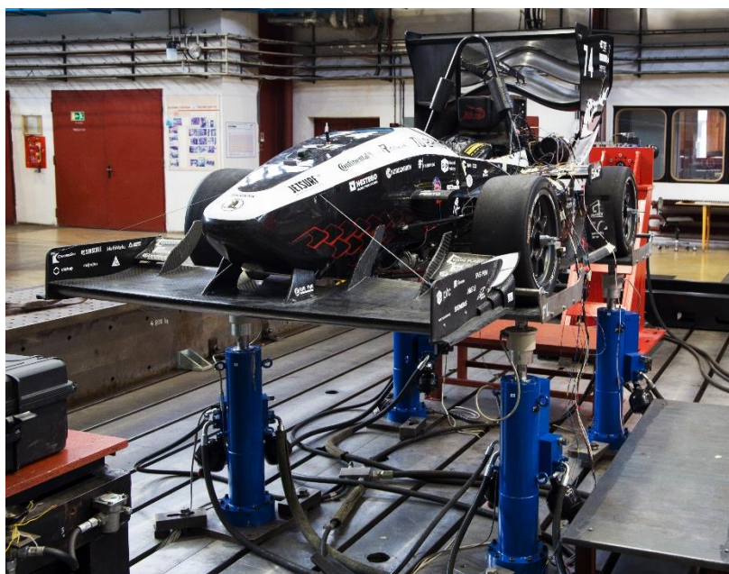
Obr. 61 Vůz D9 umístěn na hydraulických válcích pro měření vertikální dynamiky
