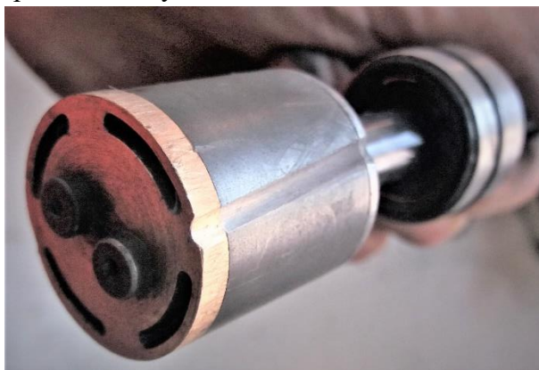
Obr. 57 Obtokové kanálky po obvodu pracovního pístu [42]
