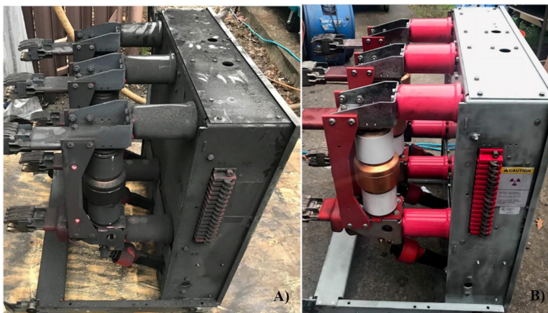
obr. 13: Vysokonapěťový jistič a) před b) po tryskání suchým ledem [41]
