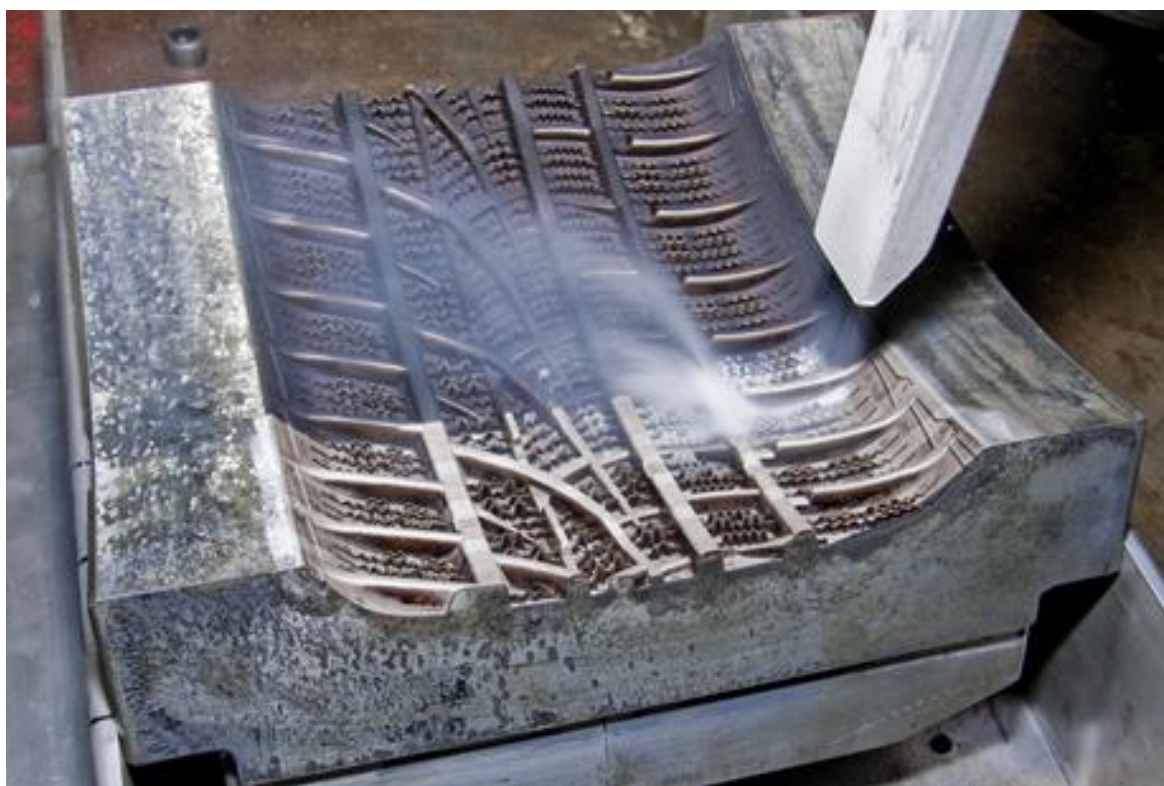
obr. 10: Čištění formy na výrobu pneumatiky [32]
