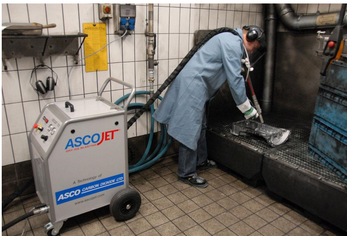
obr. 4: Proces tryskání suchým ledem [15]
