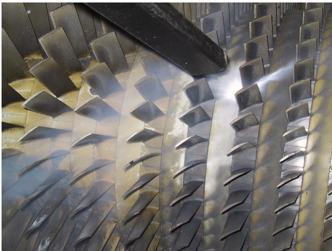
obr. 14: Čištění lopatek proudového motoru [47]
