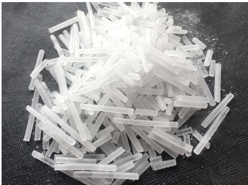
obr. 3: Pelety suchého ledu ( \varnothing 3 \text{ mm} ) [10]
