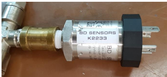
Obr. 5.7 – Snímač tlaků BD SENSORS, typ: DMP 331
