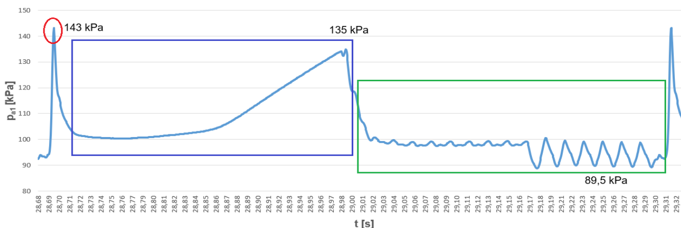
Obr. 5.16 – Naměřená data – na výtlačku použit zdroj konstantního tlaku, perioda cyklu 0,6 s
