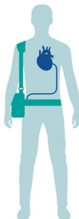
Obr. 3.4 – CARMAT TAH schéma uspořádání setu u člověka, převzato a upraveno [19]
