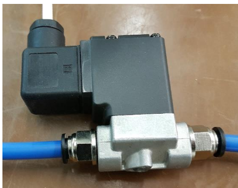
Obr. 5.6 – Rozvaděč SMC – VCA21-5DO-5-02F-Q
