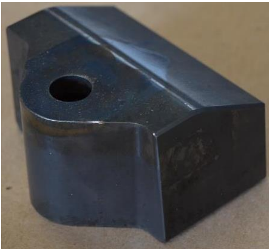
Obr. 3.2 Matrice – pohled zezadu [34].
