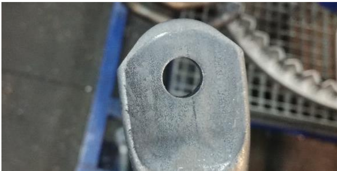
Obr. 3.7 Vzhled koncového prvku ve stavu tzv. „OK“.
