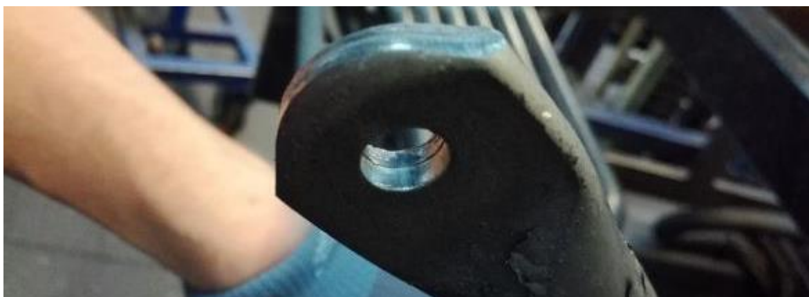
Obr. 3.8 Koncový prvek ve stavu tzv. „OK“.
