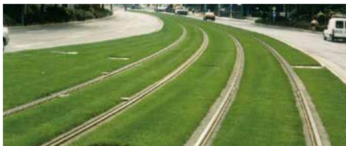
Obrázek 2.6 Trať s vysokou vegetací a speciálními bokovnicemi [6]
