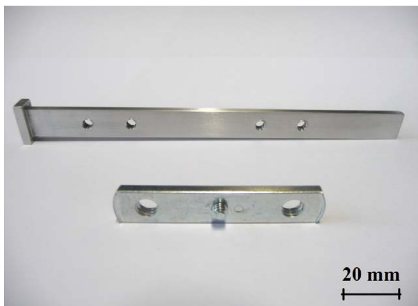
Obrázek 3.3: Porovnání původní úchytné tyče (vepředu) s navrženou (vzadu).
