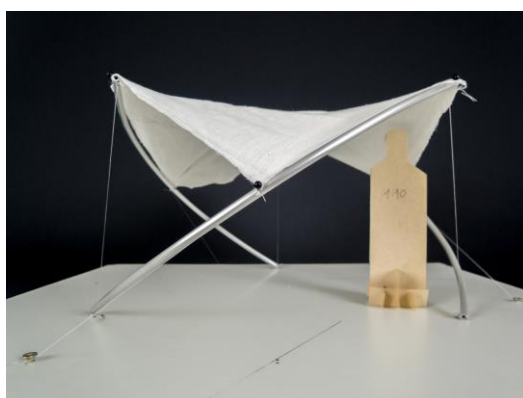
Obr.12 – Upravený Simplex předeprnutý pomocí lan
