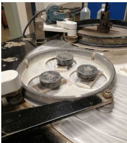
Obrázek 2.5: Strojní leštění [se svolením Meopta - optika, s.r.o.].
