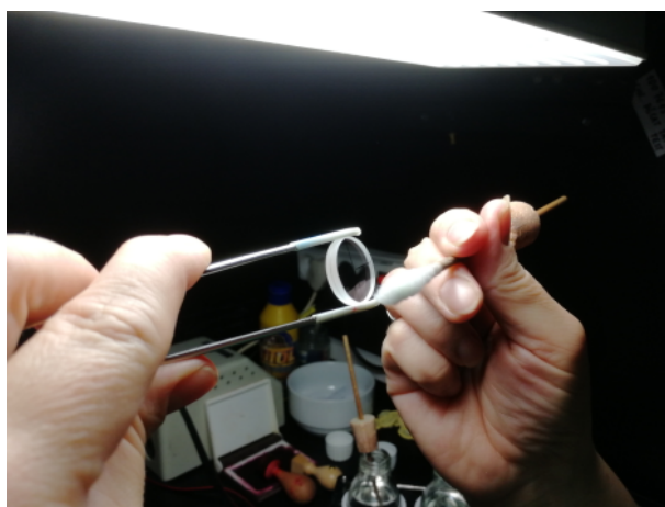
Obrázek 3.1: Ruční čištění čočky [se svolením Meopta - optika, s.r.o.].
