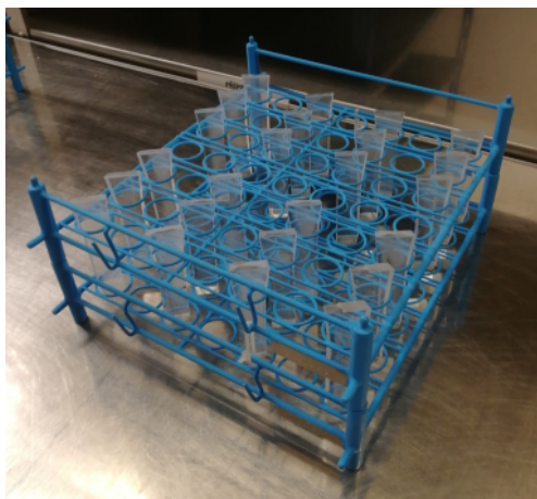
Obrázek 3.2: Mycí rámeček s polyamidovou povrchovou úpravou s kusy připravený pro mytí [se svolením Meopta - optika, s.r.o.].
