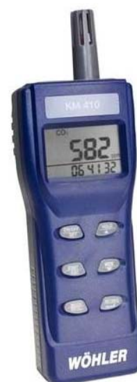
Obr. 36: Přístroj na měření teploty a CO 2 Wohler – KM 410
