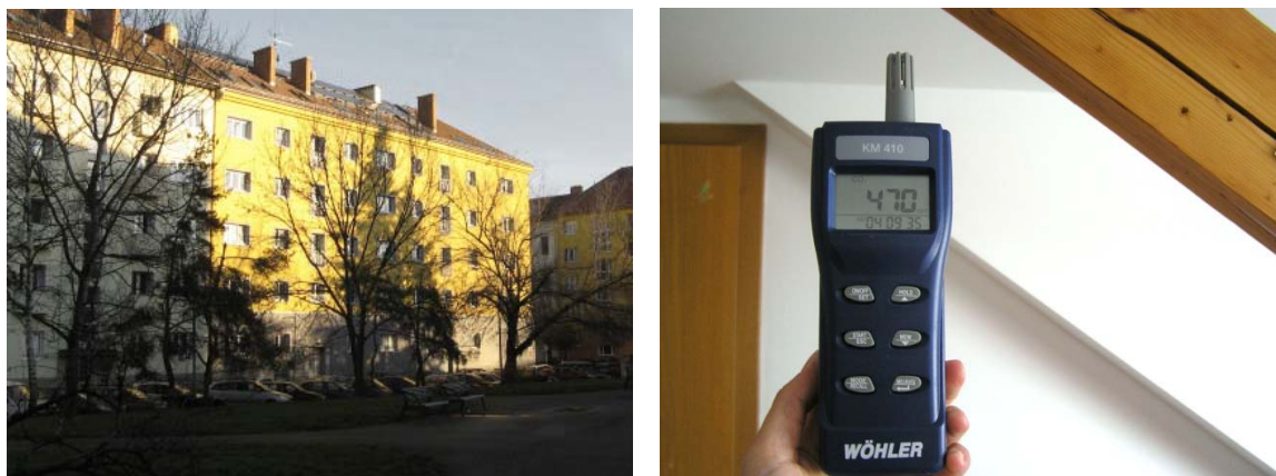
Obr. 49: Bytový dům v centru Brna a interiér podkrovní měřené místnosti. Na fotografii je vidět měření koncentrace \text{CO}_2 přístrojem WÖHLER KM 410 zapůjčeným z FA VUT v Brně, 2014, autor: L. Holopírková
