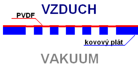
Obr. 2.4-3: Fóliový piezoelektrický parametrický měnič [16]
