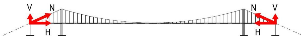
Obr. 1.2 Působení kabelu u samokotvené konstrukce
