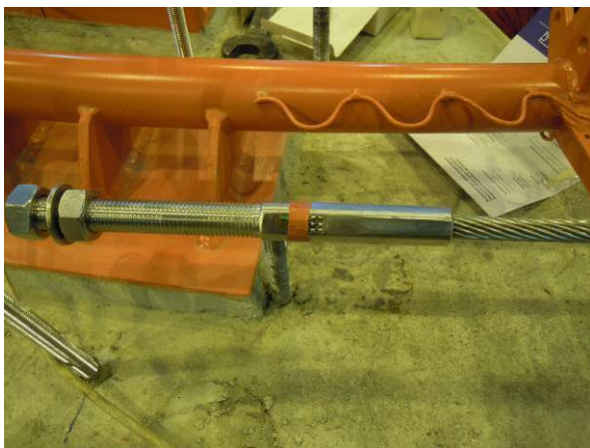
Obr. 7.14 Koncovka visutého lana s odporovými tenzometry
