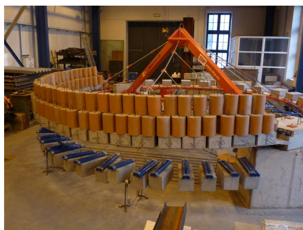
Obr. 7.34 Mezní zatěžovací zkouška pro zavěšenou část V-MZZ
