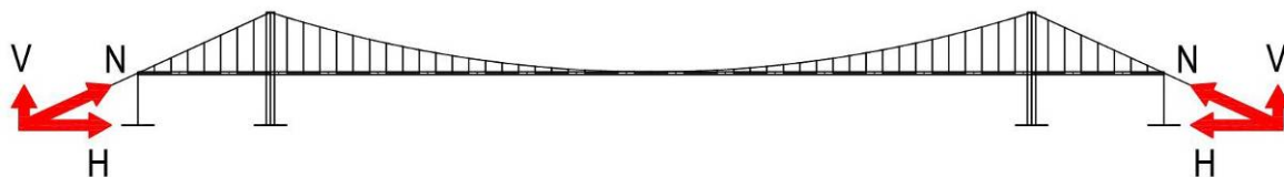
Obr. 1.1 Působení kabelu zakotveného přímo do základové půdy
