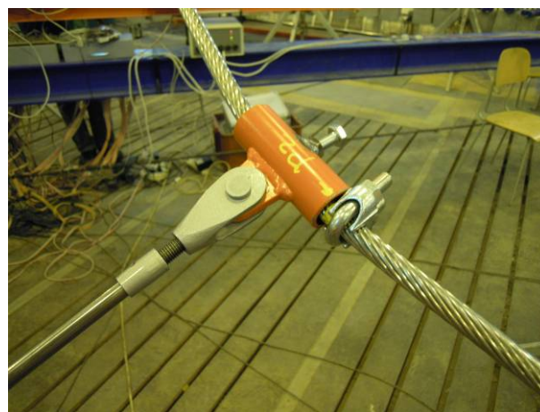
Obr. 7.4 Detail styku závěsu s visutým lanem
