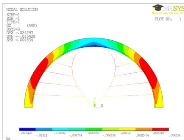
Obr. 6.17 Svislý posun uz od předběžného výchozího tvaru
