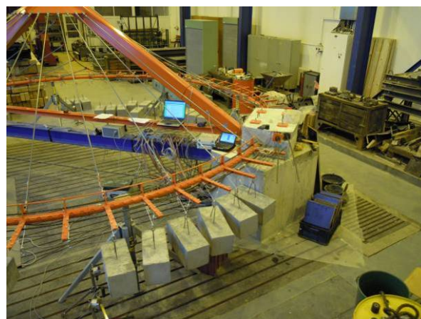
Obr. 7.17 Měřicí aparatura uvnitř modelu lávky
