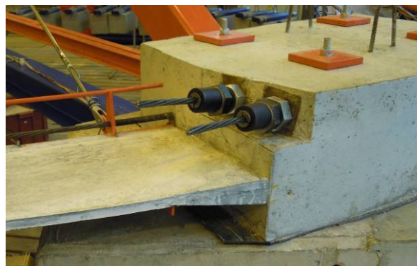
Obr. 7.22 Rektifikační šrouby na koncích
