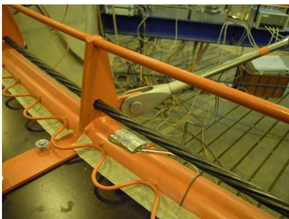
Obr. 7.16 Tenzometr na ocelové trubce na horním povrchu
