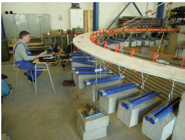
Obr. 7.48 Měřicí ústředna, indukční snímač polohy (průhybů)
