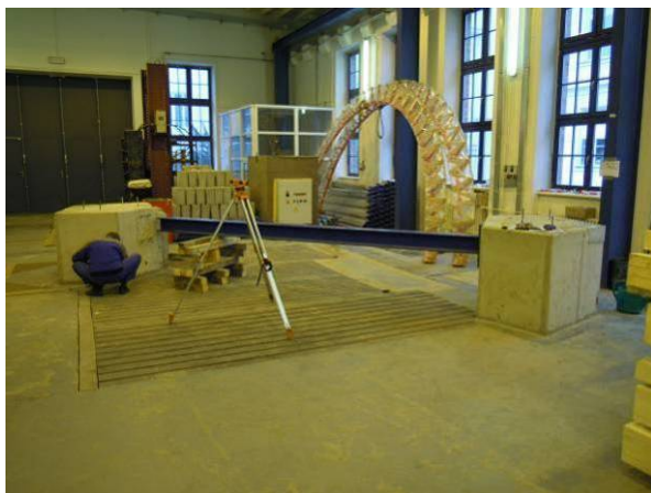
Obr. 7.6 Usazování základových bloků, předvyrobená ocelová část mostovky
