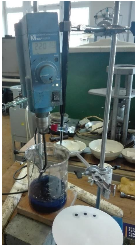
Obr. 14: Zkouška methylenovou modří – sestavení aparatury
