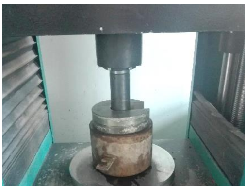
Obr. 41: CBR – penetrace trnu se zatěžovacími prstenci
