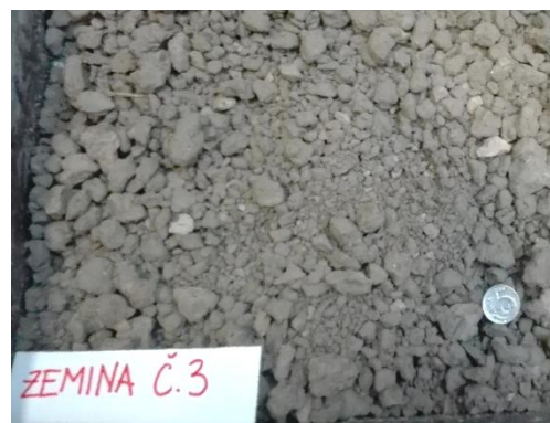
Obr. 23: Zemina č. 3 po sušení a zpracování
