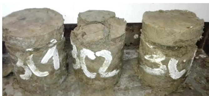
Obr. 52: Zkouška namrzavosti – tělesa ze směsi Z3C
