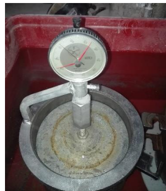
Obr. 40: CBR – saturace tělesa
