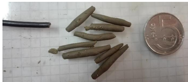
Obr. 31: Válečky o průměru 3 mm
