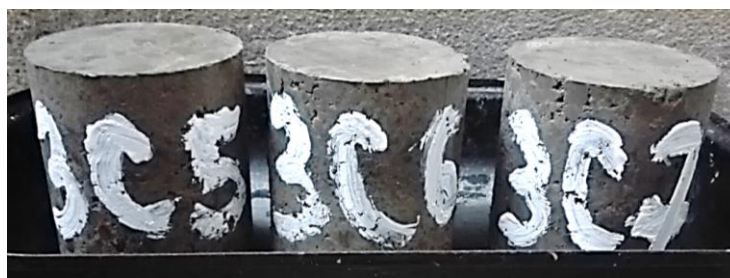
Obr. 44: Tělesa ze směsi Z3C – viditelné póry a mezery
