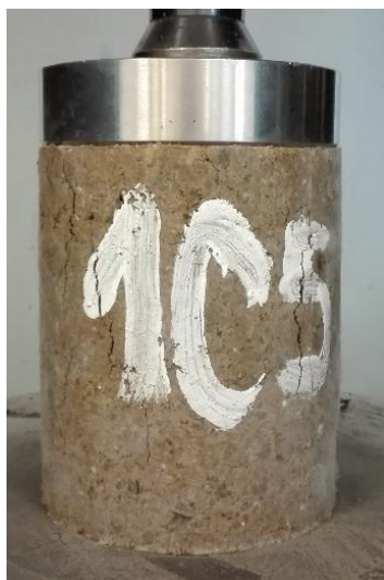
Obr. 45: Porušení tělesa ze směsi Z1C
