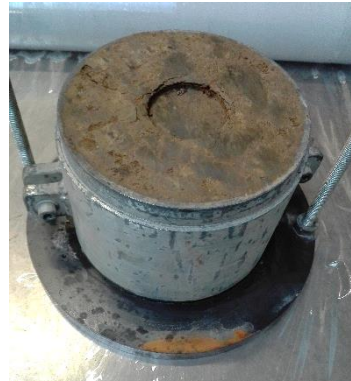
Obr. 38: IBI – těleso po penetraci trnu
