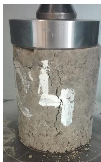
Obr. 50: Porušení tělesa ze směsi Z3V
