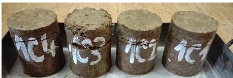
Obr. 51: Zkouška namrzavosti – tělesa ze směsi Z1C
