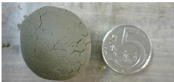
Obr. 30: Popraskaná kulička zeminy
