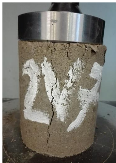
Obr. 48: Porušení tělesa ze směsi Z2V
