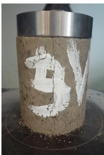
Obr. 49: Porušení tělesa ze směsi Z3C
