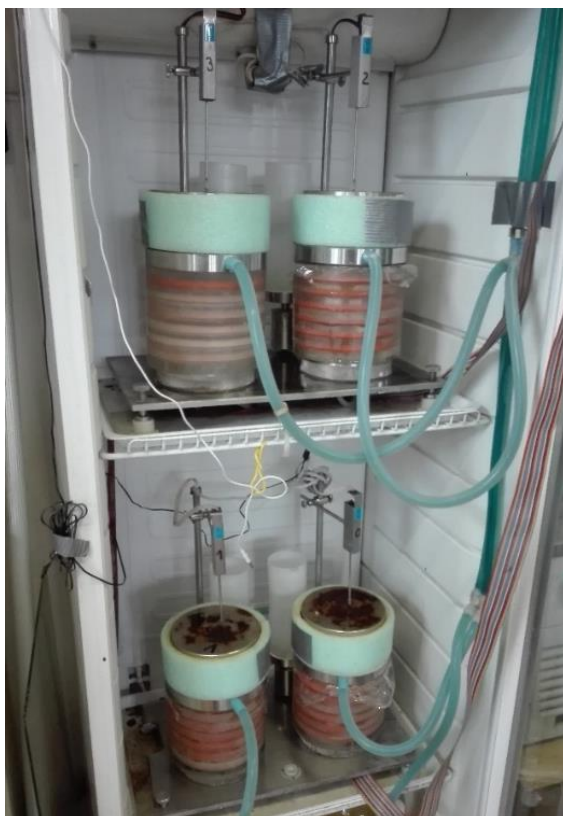
Obr. 13: Zkouška namrzavosti – chladicí skříň [26]
