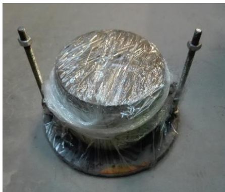
Obr. 39: CBR – zrání tělesa
