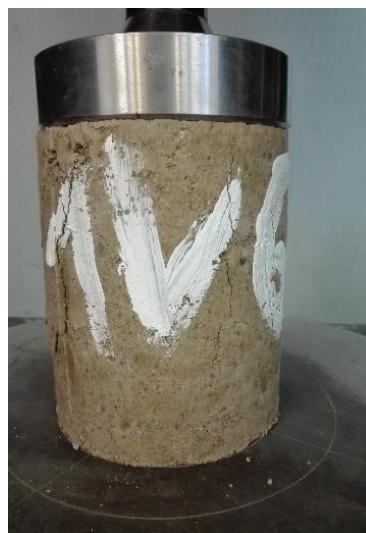
Obr. 46: Porušení tělesa ze směsi Z1V
