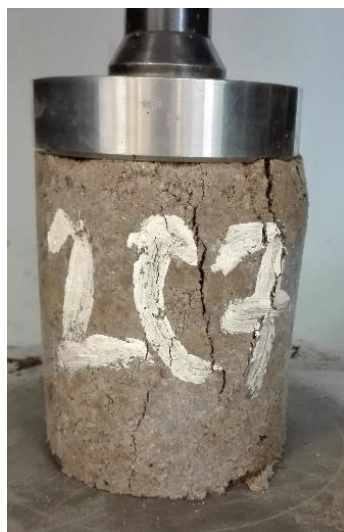
Obr. 47: Porušení tělesa ze směsi Z2C
