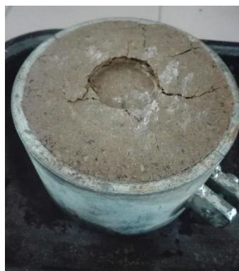
Obr. 42: CBR – těleso po penetraci trnu
