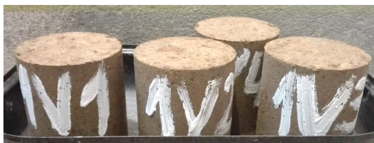
Obr. 43: Tělesa ze směsi Z1V – vizuálně kompaktní
