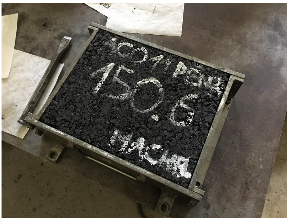
Obrázek 39: Zkušební deska nachystaná k provedení zkoušky pojíždění kolem
