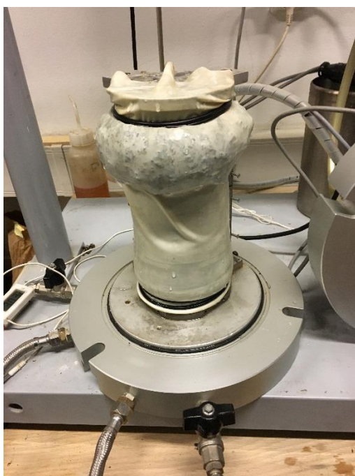
Obrázek 40: Poškozený vzorek v triaxiálním zařízení
