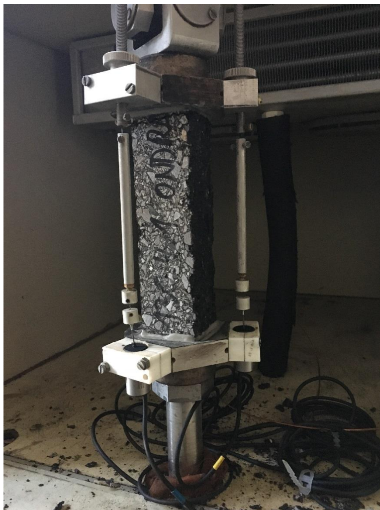
Obrázek 36: Porušený vzorek po stanovení nízkoteplotních vlastností
