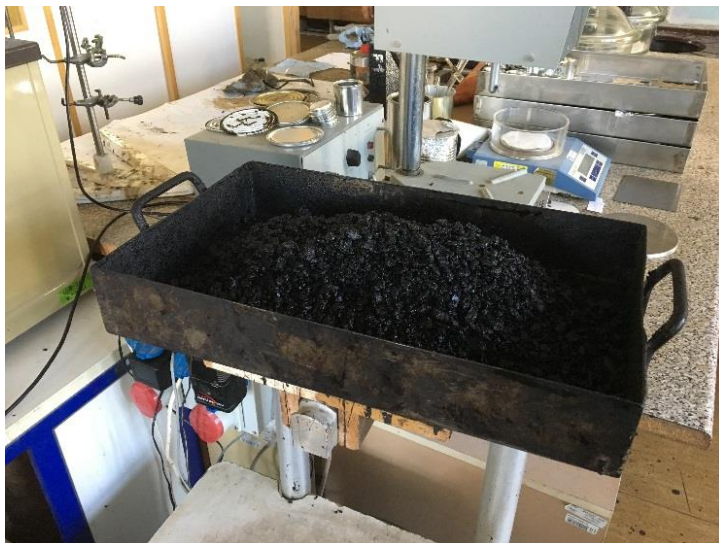
Obrázek 16: Navážka asfaltové směsi
