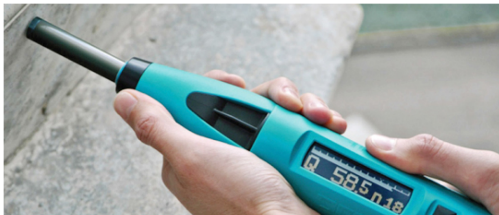
Obr. 1 Skúška odrazovou metódou - kladivko Proceq Silver Schmidt PC/ST [6]
