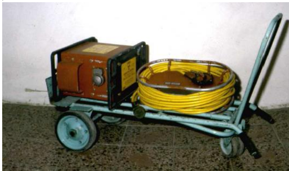
Obr. 6 Radiografický uranový kryt TECH/OPS [3]
