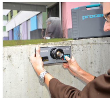
Obr. 12 Prístroj používaný k odtrhovým skúškám DY-225 Family (Pull-Off Testing) [14]
