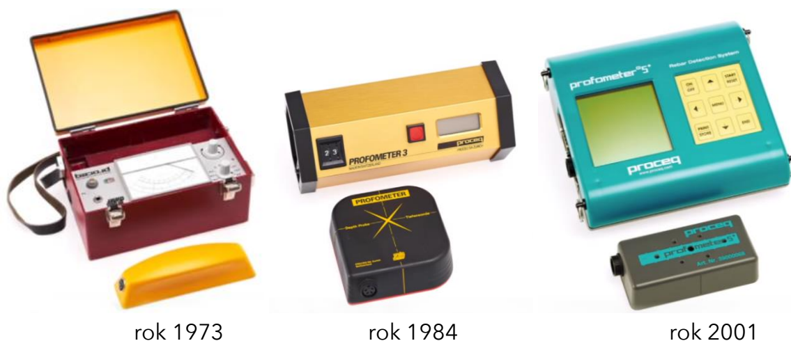
Obr. 4 Vývoj prístrojov Profometer švajčiarskej spoločnosti Proceq [7]
