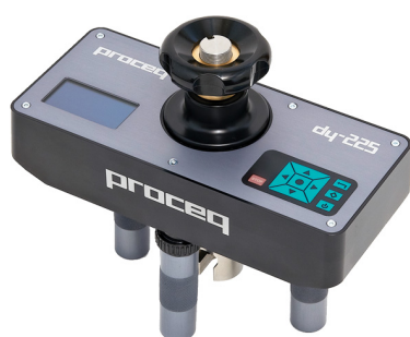
Obr. 12 Prístroj používaný k odtrhovým skúškám DY-225 Family (Pull-Off Testing) [14]
