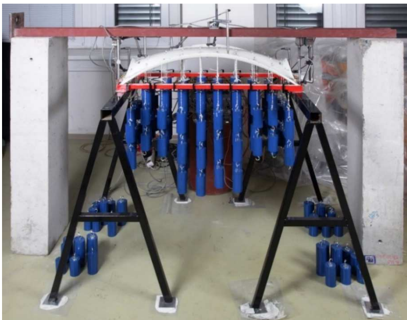
Obr. 10-40 Uspořádání experimentu při kombinaci zatížení SW+SN4
