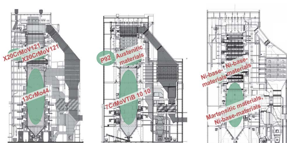
Obr. 2.3 Použité materiály u kotlů (zleva) Generace 600, 700 a 800 [11]
