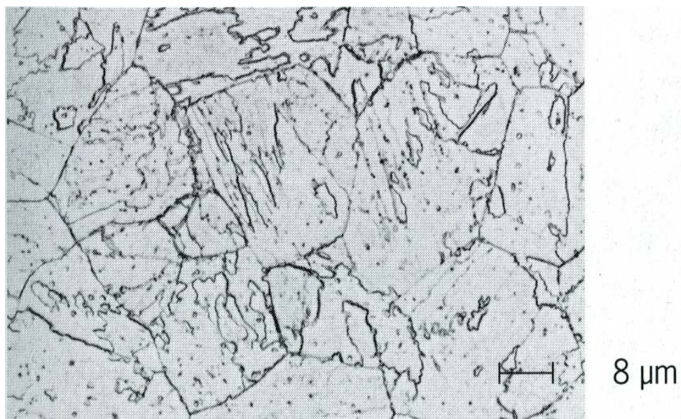
Obr. 3.10 Popuštěná bainiticko-martenzitická struktura oceli T24 [14]
