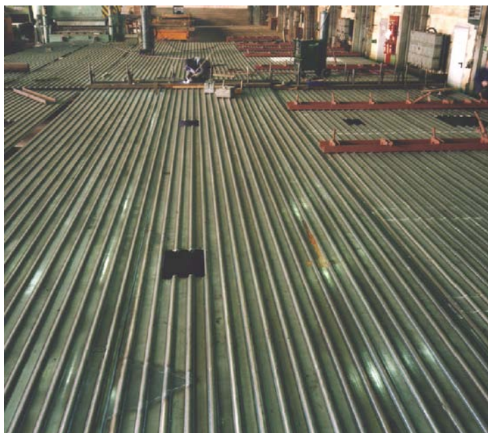
Obr. 3.4 Svařovaná membránová stěna parního kotle [11]
