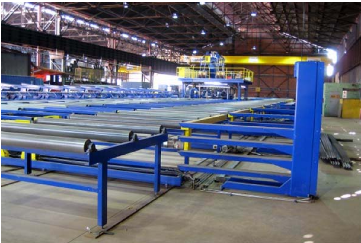
Obr. 4.2 Linka na svařování membránových stěn metodou APT
