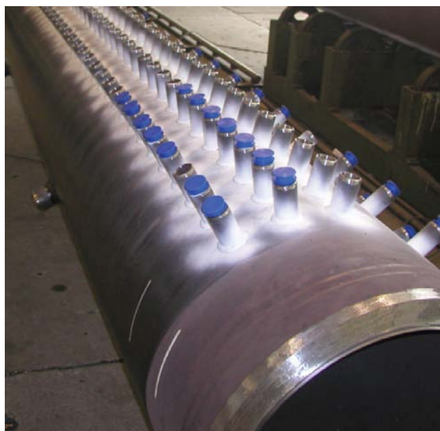
Obr. 3.8 Sběrač páry u membránového parního kotle [11]
