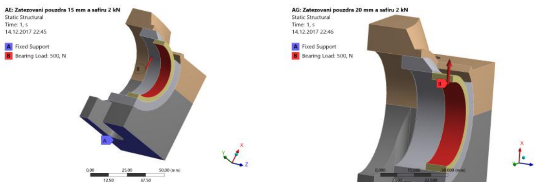
Obr. 7.9 Vstupní podmínky analýzy zatěžování, 15 mm průzor (vlevo) a 20 mm průzor (vpravo).
