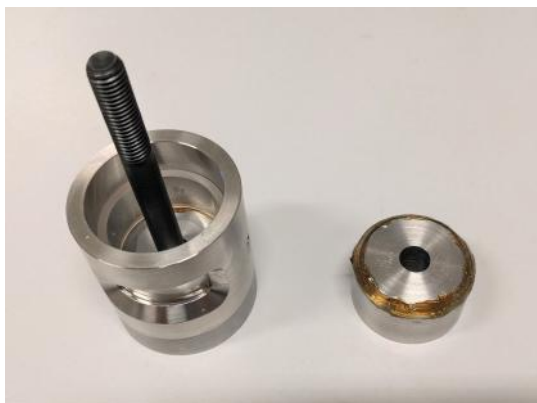
Obr. 4.13 Nanášení plastického maziva a kompletace přípravku před aplikací lepidla.
