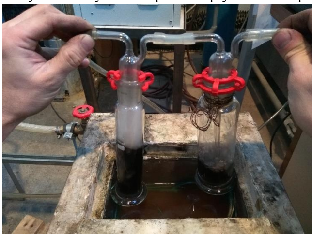
Obr. 4.2.2: Filtrace plynu před analyzátozem
