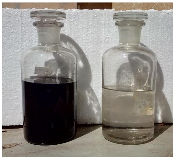
Obr. 4.1.2: Vzorek dehtu po vyjmutí z chladicí lázně Obr. 4.1.3: Zachycený dehet ve vzorkovnicích
