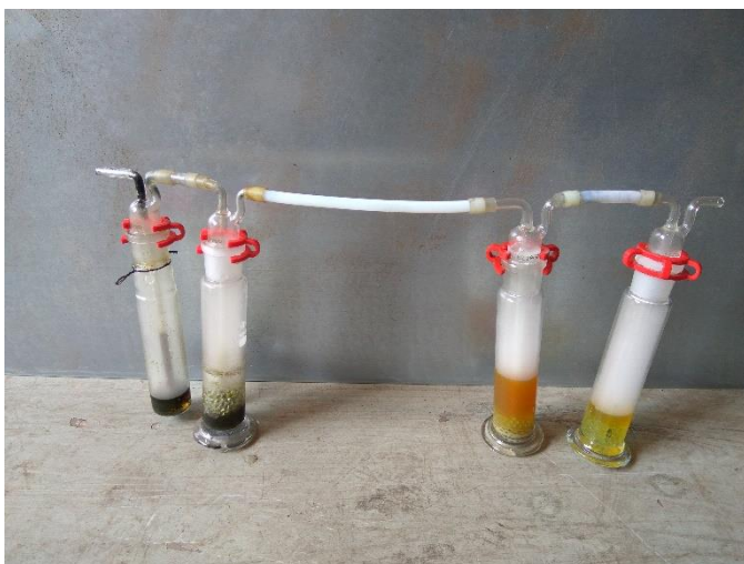
Obr. 4.1.2: Vzorek dehtu po vyjmutí z chladicí lázně Obr. 4.1.3: Zachycený dehet ve vzorkovnicích
