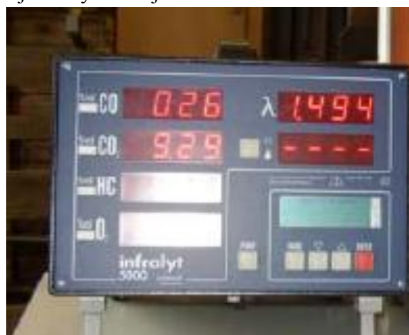
Obr. 4.2.3: Online analyzátor plynu Infraclyt 5000
