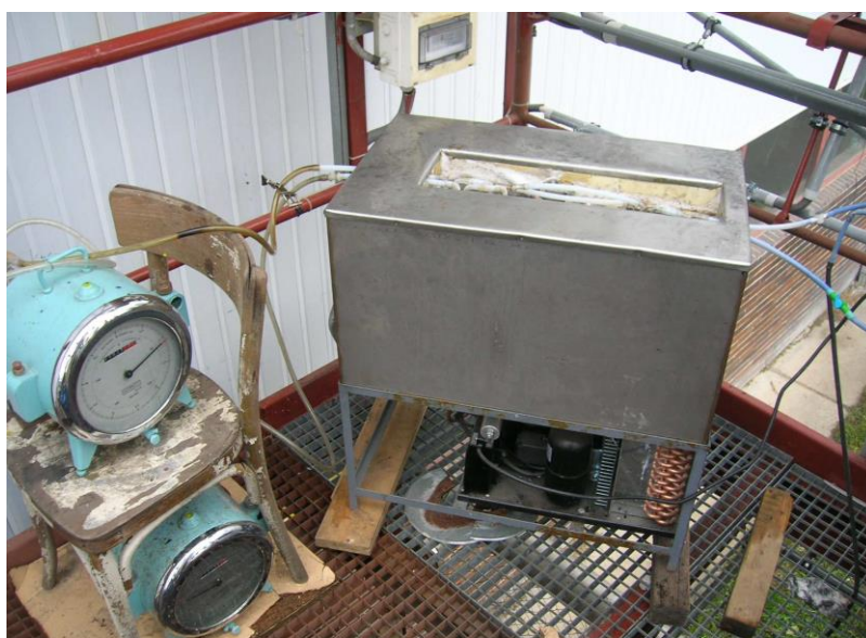
Obr. 4.1.4: Odběrová trať pro zachycování dehtů [3]
