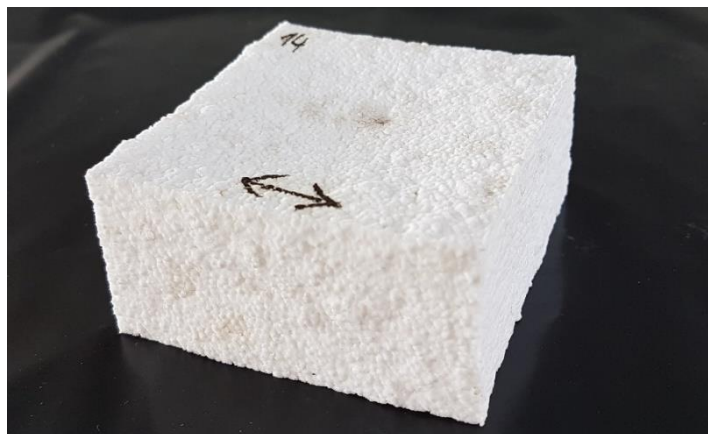
Obrázek 3.2 - Vzorek vystavený teplotě 110 °C
