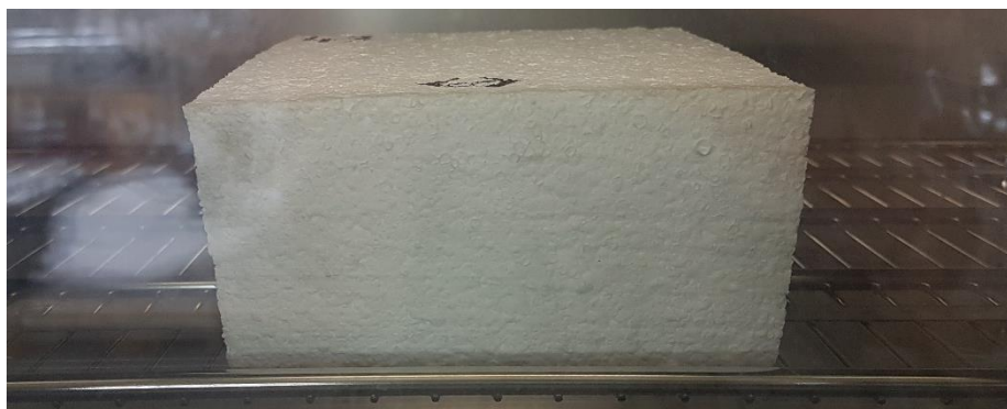
Obrázek 3.4 - Nepravidelné zkroucení vzorku při zahřívání
