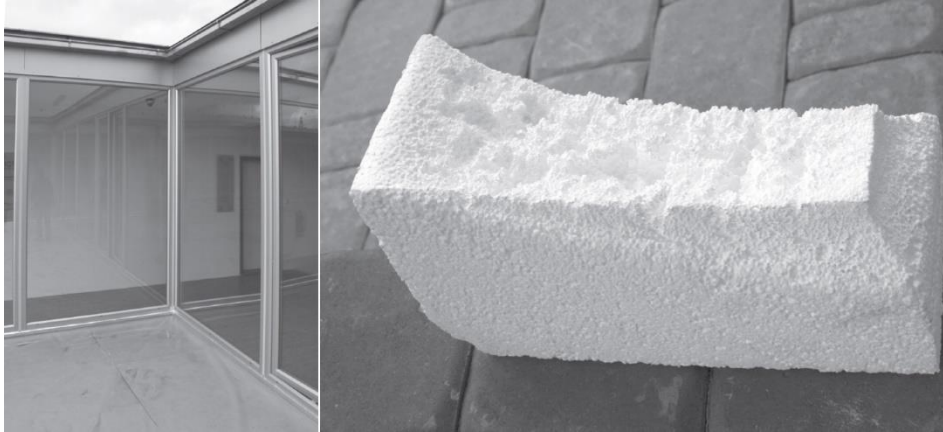
Obrázek 1.4 - Poškozený EPS – Atrium [3]
