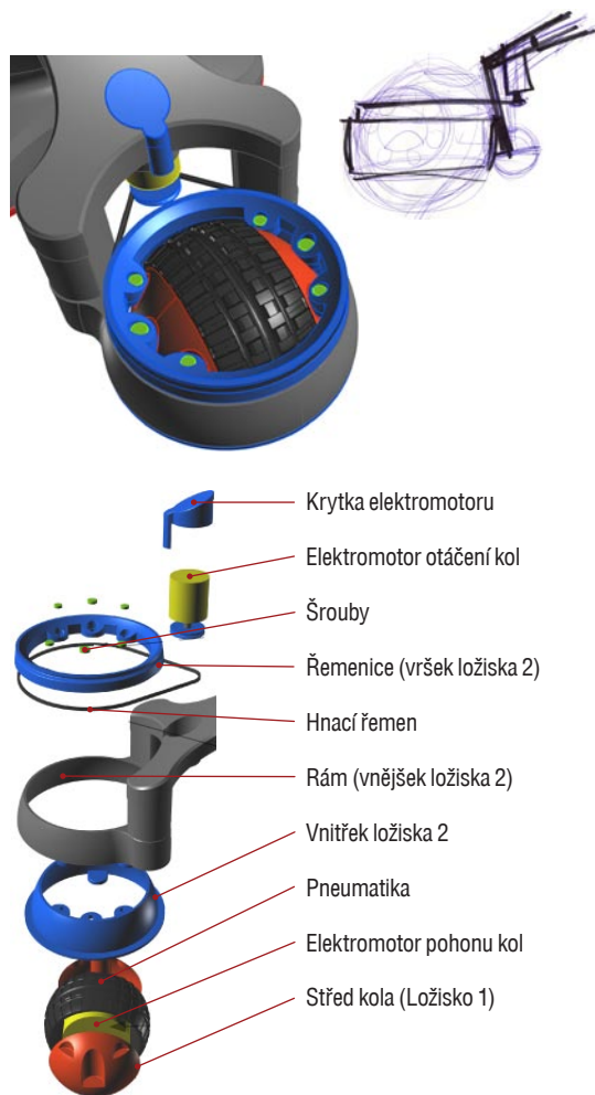
29/ Schéma konstrukce sférického kola + prvotní skica
