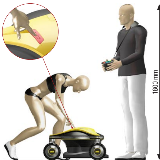
64/ Rozměrová studie + vypnutí hlavního spínače
