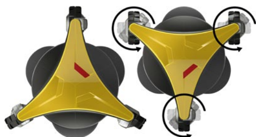
47/ Nouzová brzda + princip zatáčení kol (Synchrodrive)
