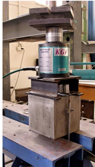
Obr. 9: Schéma pull-out testu při zkoušení centrické výztuže
