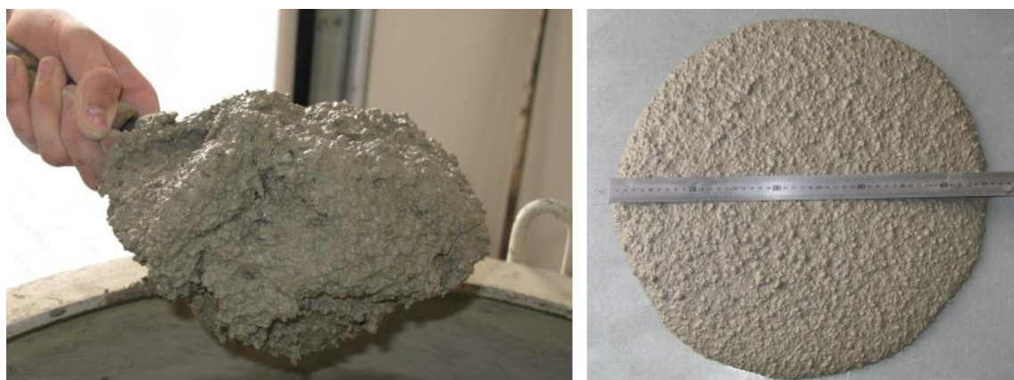
Obr. 4: Detail „nadýchané“ konzistence a stupeň rozlití F3 (450 mm) ULC D1,0 – Liapor
