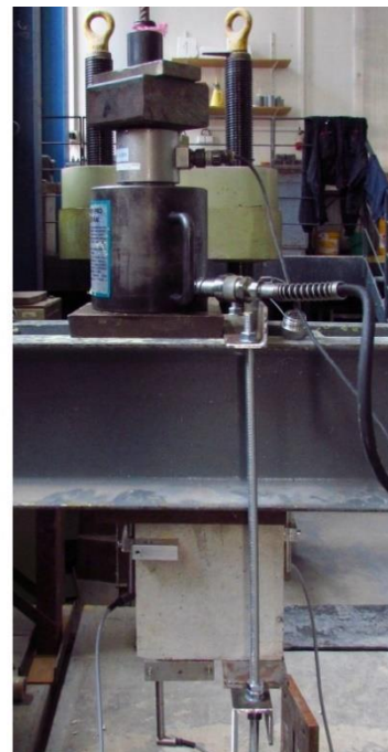
Obr. 10: Schéma a provedení pull-out testů s excentricky umístěnou výztuží
