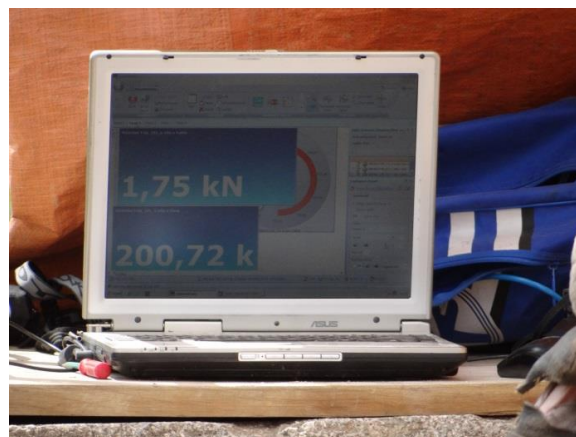
Obr. 7.84 Síla v ocelovém táhle (nahore) a síla v napnutém laně (dole)
