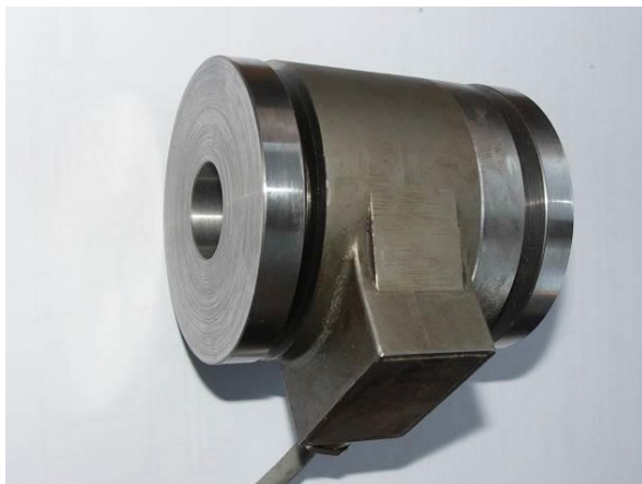
Obr. 7.5 Siloměr s roznášecími podložkami
