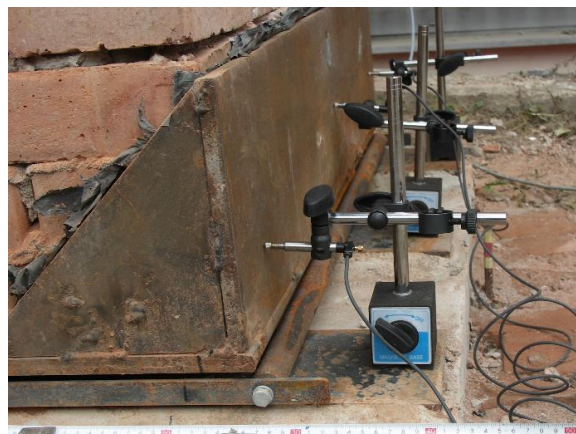
Obr. 7.64 Měření posunu paty klenby po valivém ložisku
