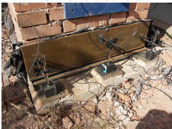
Obr. 7.33 Měření vodorovného posunu paty klenby U_x
