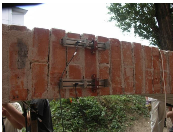
Obr. 7.72 Hollanové můstky ve vrcholu klenby, H\_V\_Horní/Dolní
