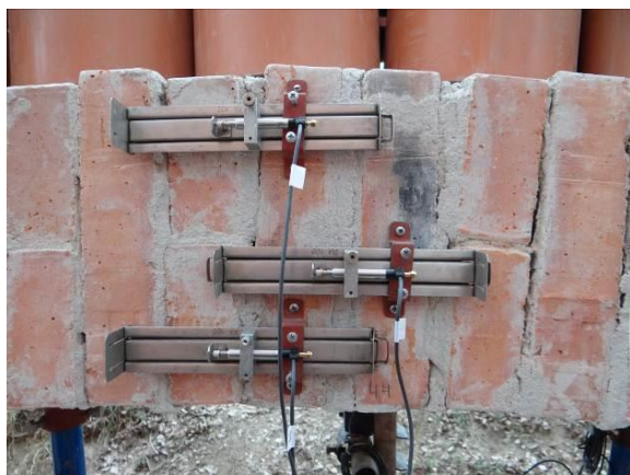
Obr. 7.18 Hollanovy můstky ve vrcholu klenby s osazenými indukčnostními snímači
