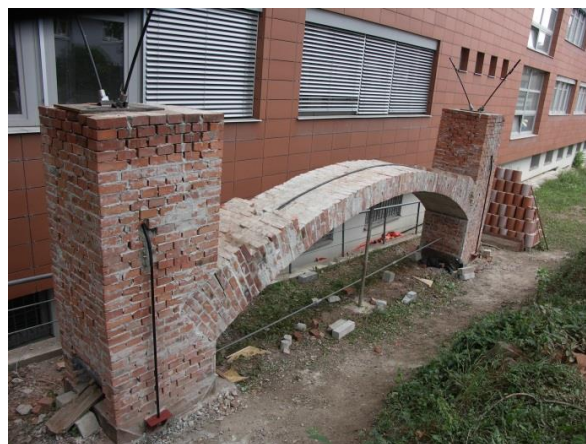
Obr. 7.48 Svisle sepnuté pilíře
