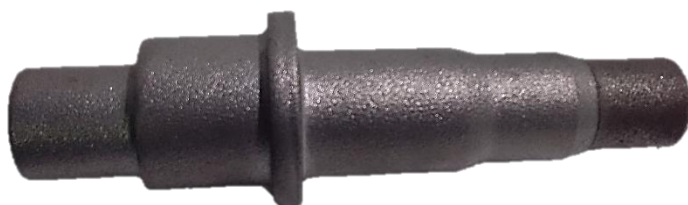
Obr. 12 Výrobek stranového protlačování
