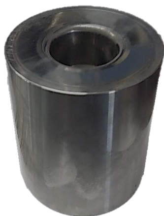
a) průtlačnice pro pastorek – uvnitř redukční kužel pro redukci dříku
