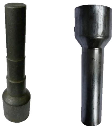
Obr. 11 Výrobky dopředného protlačování
