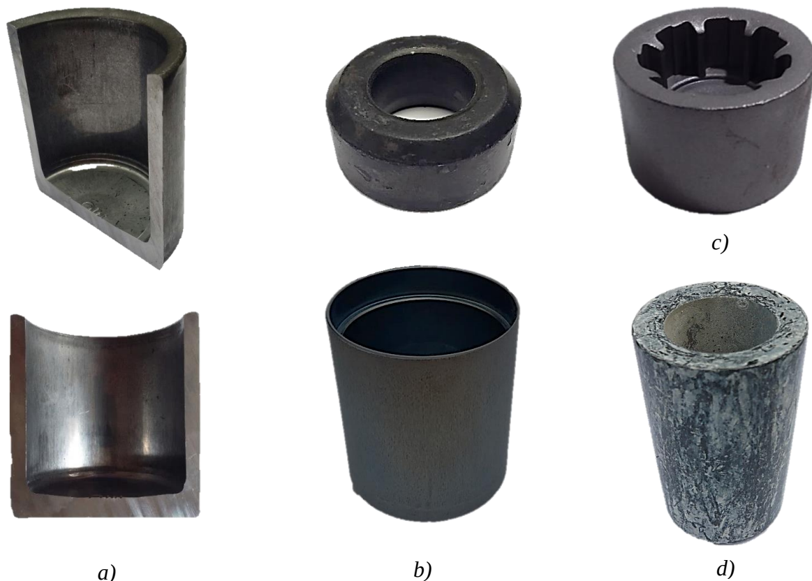
Obr. 9 Výrobky zpětného protlačování
