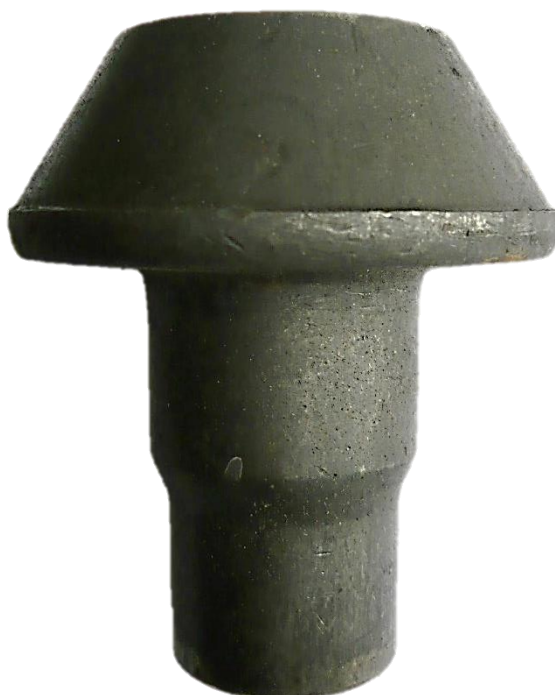
Obr. 30 Hotový pastorek vyjmutý z lisu
