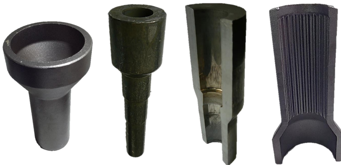
Obr. 15 Výrobky sdruženého protlačování
