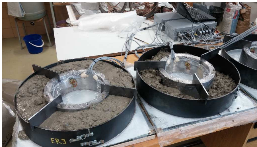
Obr. 5.4 Ukládání čerstvého betonu do forem Ring3
