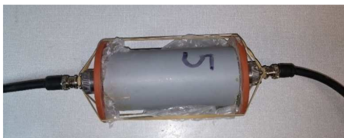
Obr. 4.19 Měření doby průchodu ultrazvukového signálu skrz vzorek z mikro-betonu
