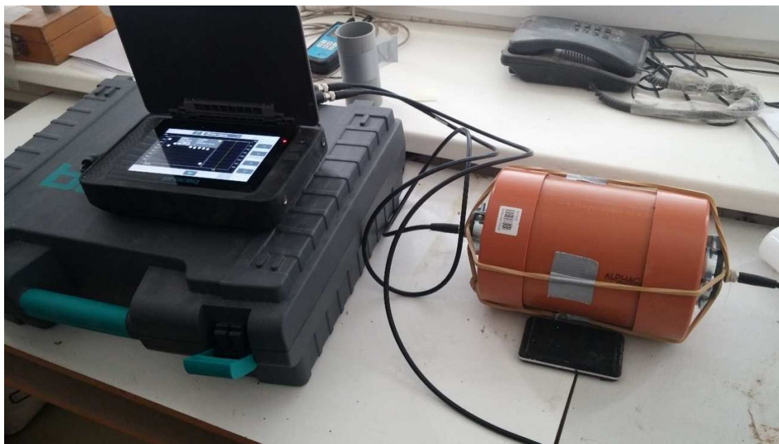
Obr. 5.8 Měření průchodu ultrazvukového signálu pomocí Pundit PL-200
