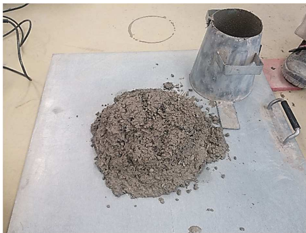
Obr. 5.37 Zpracovatelnost betonu C-PP9kg (zkouška rozlitím)
