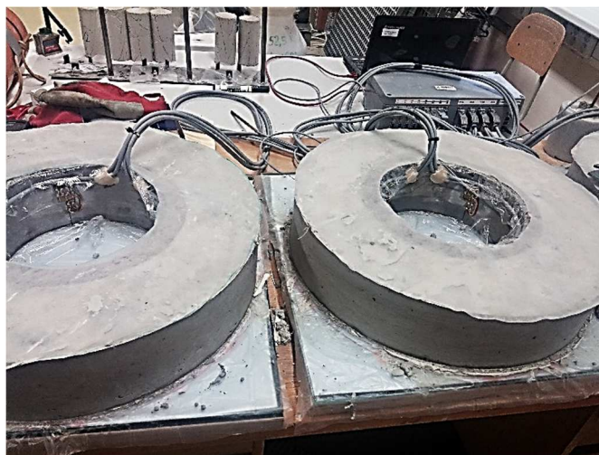
Obr. 5.52 Stav bez trhlín při Ring-testu betonu C-Fiber
