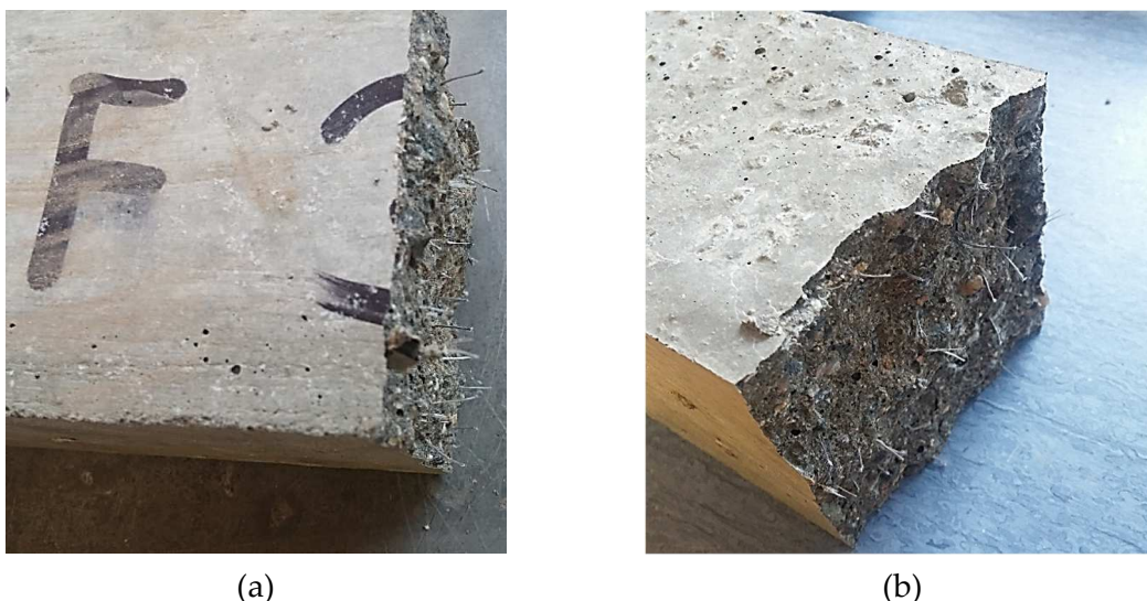
Obr. 5.39 Zlomky trámců s polypropylenovými vlákny FortaFerro (a) C-PP4kg; (b) C-PP2kg
