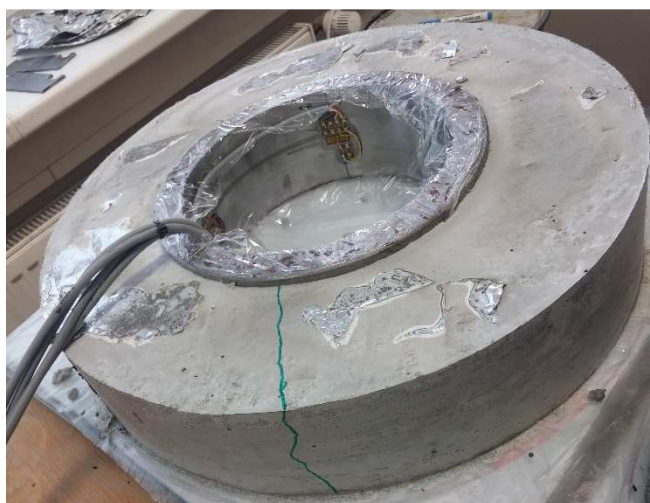
Obr. 5.23 Smršťovací trhlinka betonu C-Ref (zvýrazněna zeleně)
