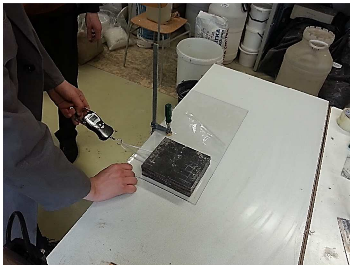
Obr. 4.7 Zkoušení různých podkladů a jejich úprav povrchů pro Ring-test
