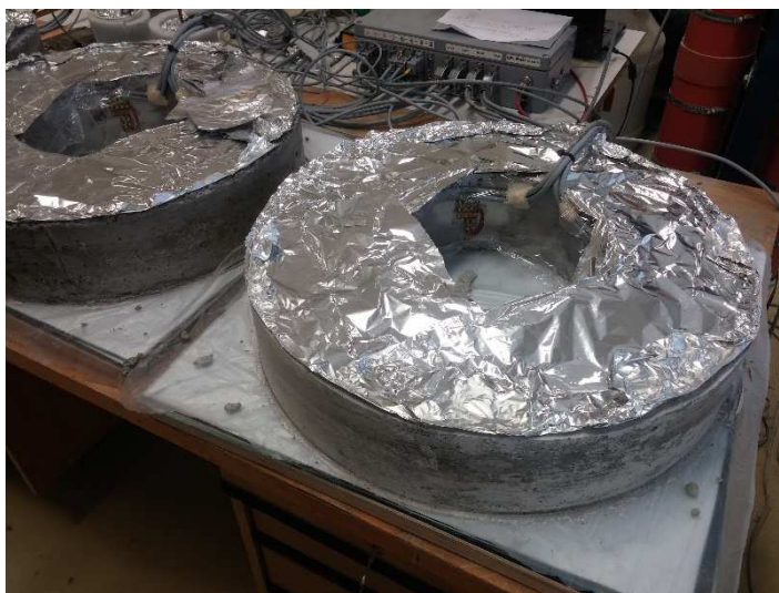
Obr. 5.5 Sledování vázaného smršťování betonů pomocí Ring-testu
