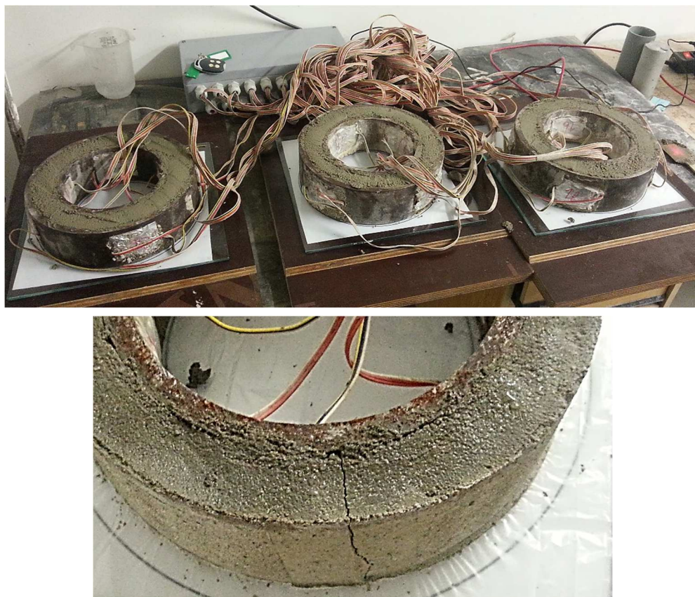
Obr. 4.31 Uložení čerstvého mikro-betonu MC-Ref ve formě Ring
