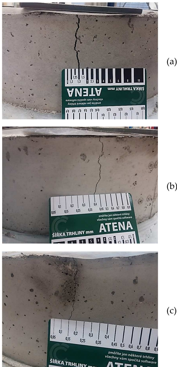
Obr. 5.45 Smršťovací trhlina při Ring-testu při testování vláknobetonů (a) C-NonF; (b) C-PP2kg; (c) C-PP4kg
