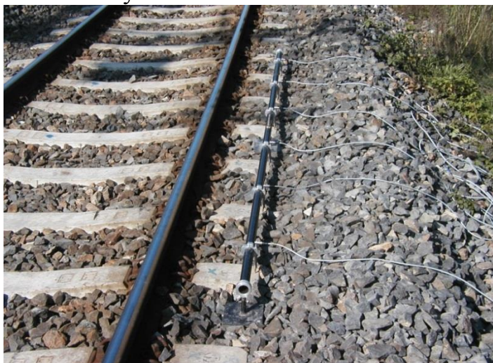
Obr. 6 Měřicí rám pro sledování poklesů pražců pod zatížením; zdroj: ÚŽKS
