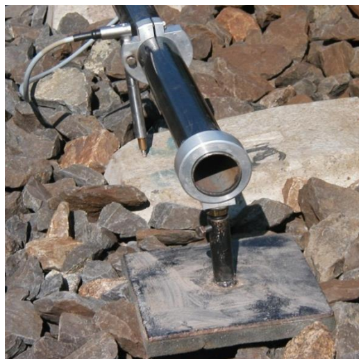
Obr. 6 Měřicí rám pro sledování poklesů pražců pod zatížením; zdroj: ÚŽKS
