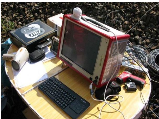
Obr. D-29 Měřicí ústředna DEWE 2502; Hranice na Moravě
