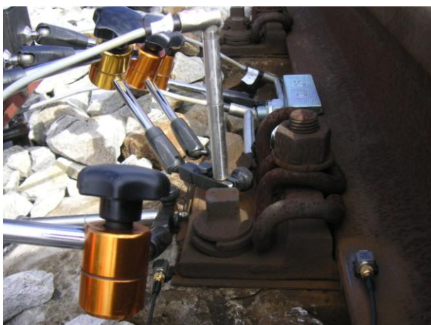
Obr. C-75 Detail osazení snímačů; Kamenný Malíkov
