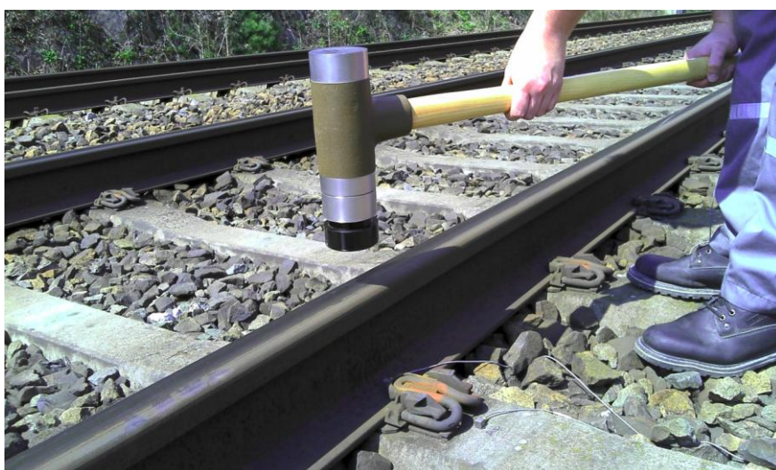
Obr. B-4 Buzení rázovým kladivem
