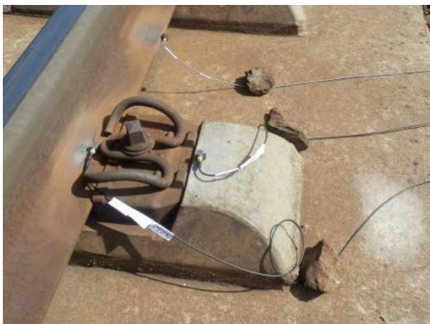
Obr. E-27 Detail osazení snímačů; pevná jízdní dráha
