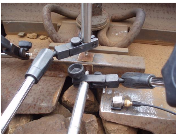
Obr. C-69 Detail osazení snímačů; Popelín
