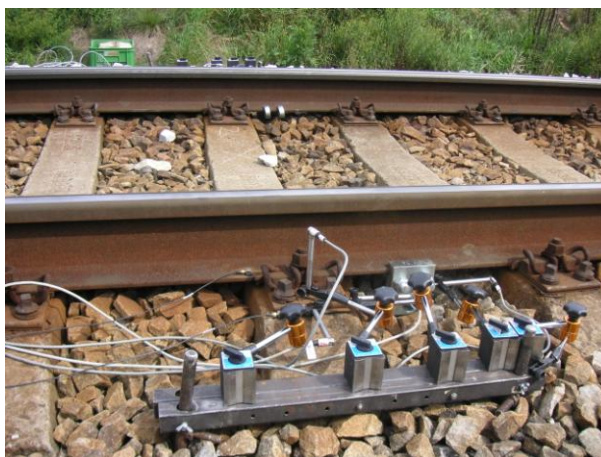
Obr. C-74 Umístění snímačů na hlavě betonového pražce; Kamenný Malíkov
