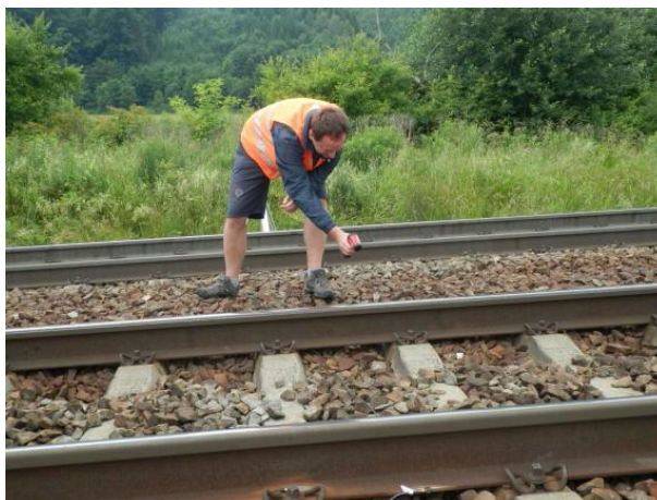
Obr. E-28 Měření teploty kolejnicových pásů
