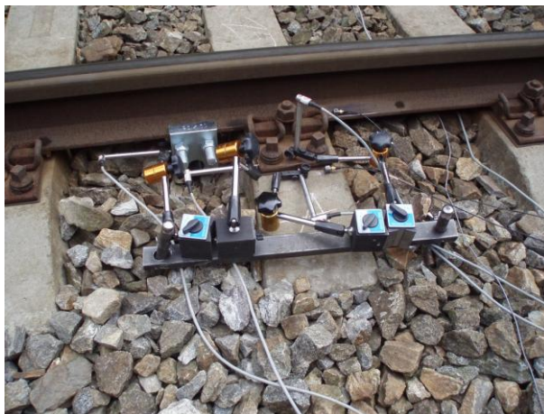
Obr. C-62 Umístění snímačů na hlavě betonového pražce; Počátky-Žirovnice
