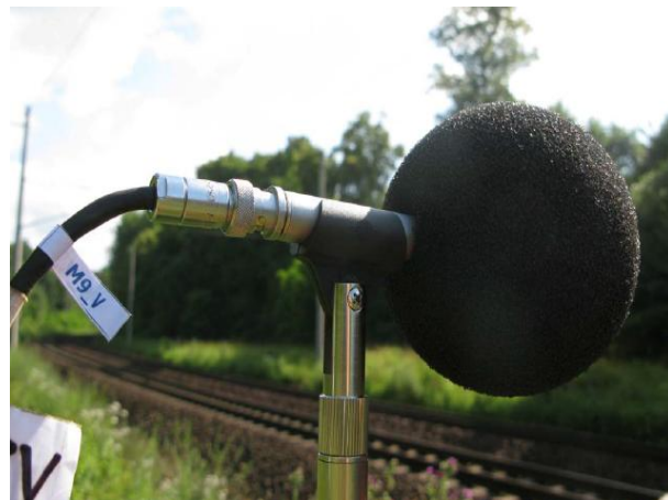
Obr. D-34 Detail mikrofonu ve vzdálenosti 7,5 m od osy koleje; Napajedla
