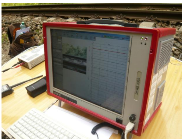
Obr. C-64 Integrovaná PC ústředna DEWETRON 2502; Počátky-Žirovnice
