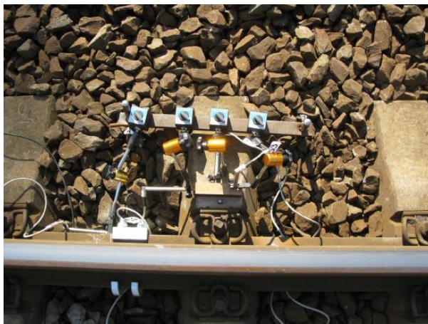
Obr. D-26 Umístění snímačů v hlavové části pražce; Hranice na Moravě
