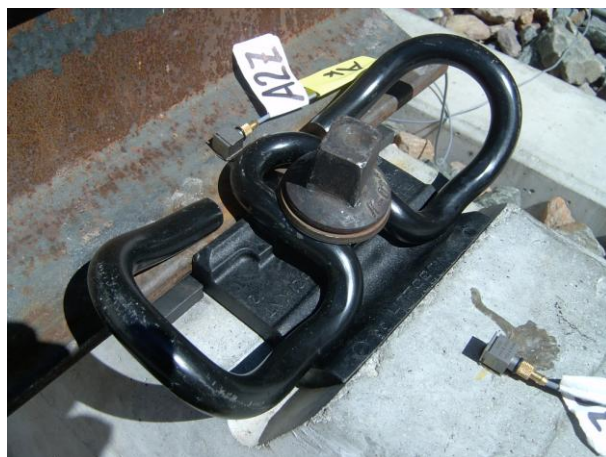
Obr. A-31 Detail uzlu upevnění Vossloh W 28NT
