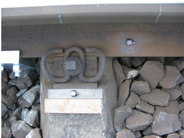
Obr. D-25 Příprava snímačů zrychlení; Hranice na Moravě
