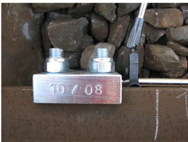
Obr. D-33 Přípravek pro opření měřicího hrotu snímače pohybu; Napajedla
