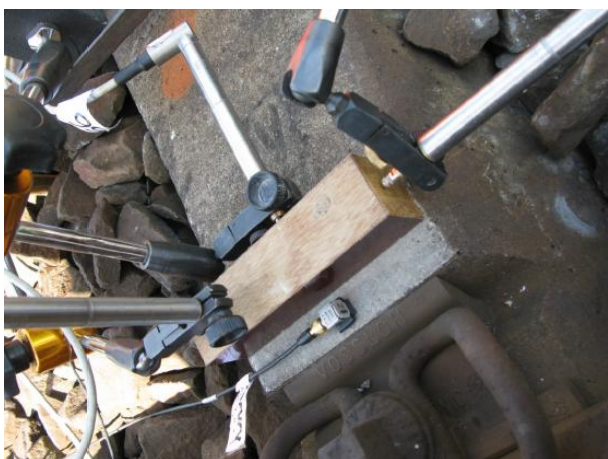
Obr. D-27 Přípravek pro opření měřicích hrotů snímačů pohybu; Hranice na Moravě
