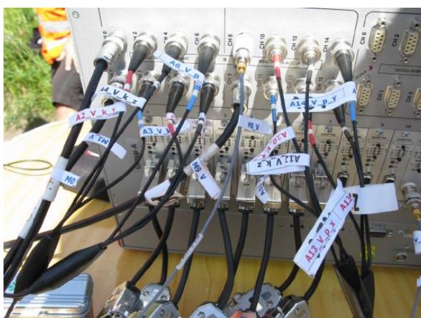
Obr. D-30 Měřicí ústředna DEWE 2502; Hranice na Moravě
