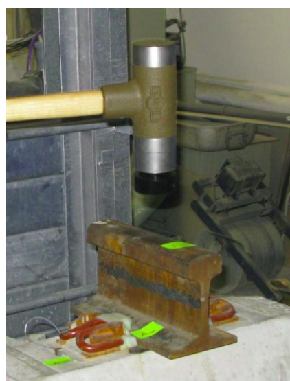
Obr. A-27 Buzení rázovým kladivem
