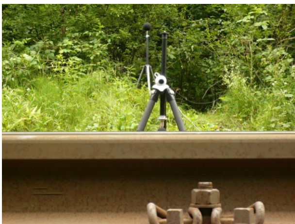
Obr. C-63 Umístění hlukových mikrofónů a kamery pro detekci polohy vlaku; Počátky-Žirovnice
