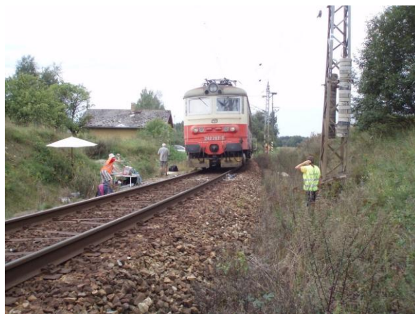
Obr. C-72 Průjezd rychlíku měřicím stanovištěm; Popelín
