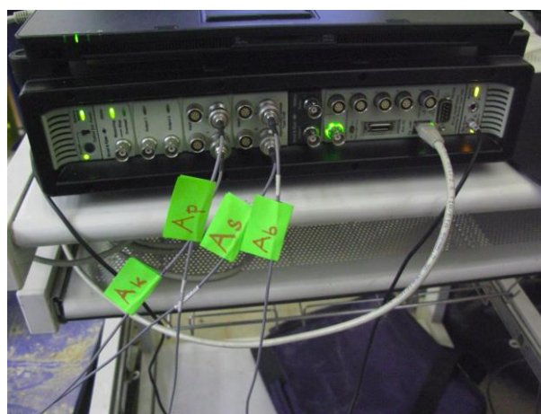
Obr. A-27 Buzení rázovým kladivem
