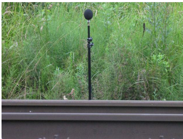
Obr. D-28 Mikrofon ve vzdálenosti 7,5 m od osy koleje; Hranice na Moravě
