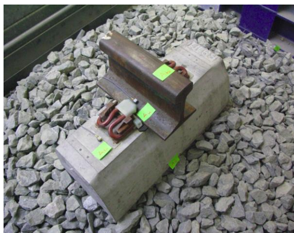
Obr. A-25 Osazení čidel na vzorku Pandrol FC I
