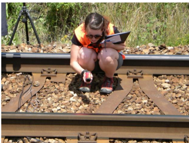
Obr. C-71 Měření teploty kolejnicových pásů; Popelín
