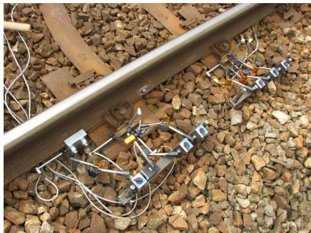
Obr. C-68 Umístění snímačů na rozšířeném konci ocelového pražce; Popelín
