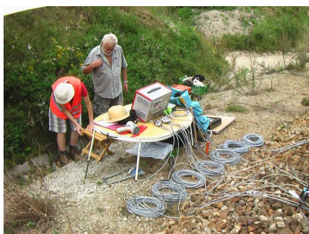
Obr. C-70 Zapojení čidel k měřicí ústředně; Popelín
