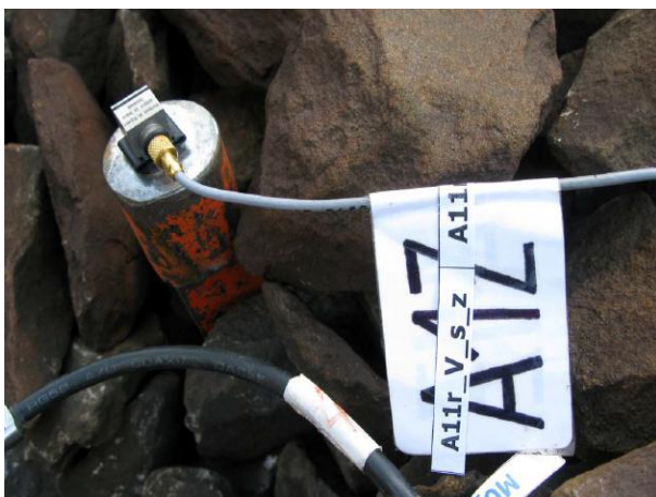
Obr. D-31 Akcelerometr na patě kolejového lože; Napajedla
