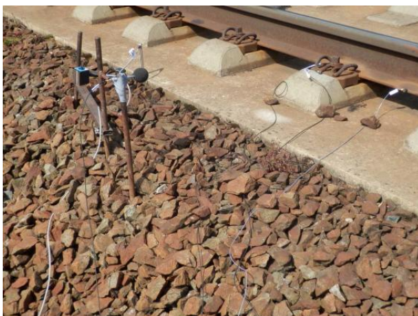
Obr. E-25 Pohled na měřicí stanoviště; pevná jízdní dráha
