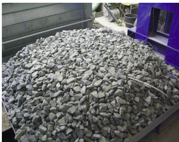
Obr. A-24 Příprava kolejového lože pro zkoušky v laboratoři
