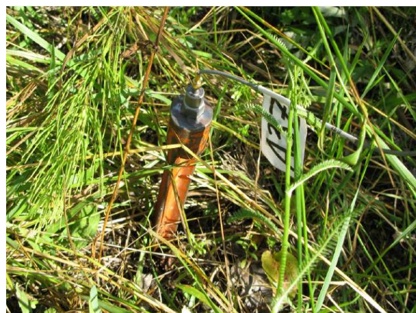
Obr. D-32 Akcelerometr ve vzdálenosti 7,5 m od osy koleje; Napajedla
