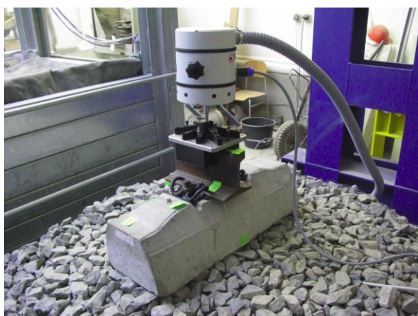
Obr. A-28 Buzení elektrodynamickým budičem
