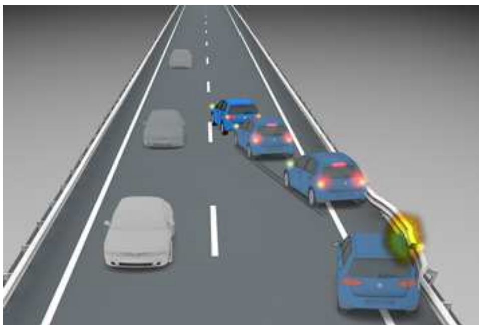
Obr. 5 Zastavení vozidla po nárazu pomocí MCB [16]
