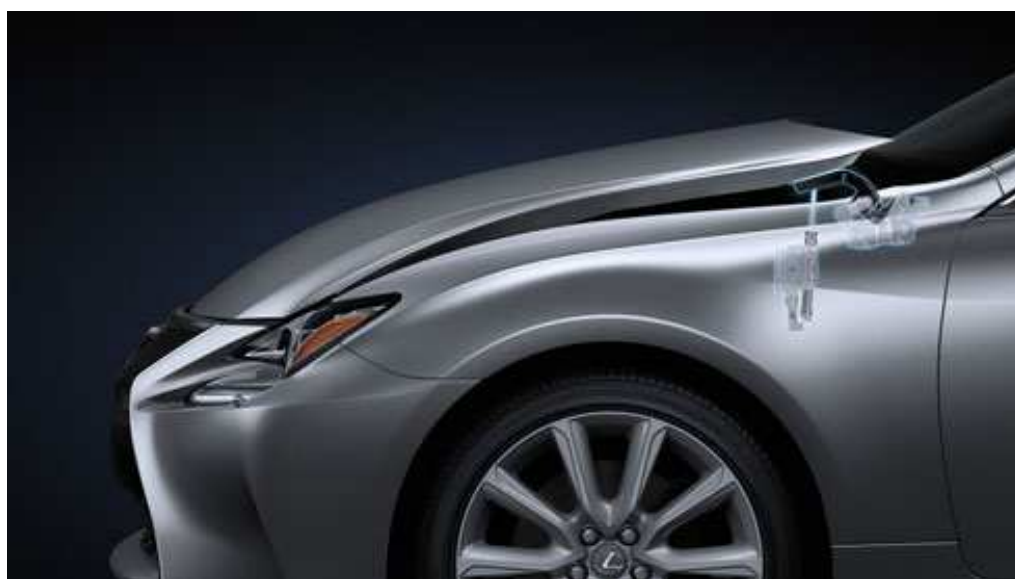
Obr. 16 Systém zvednutí kapoty u vozu Lexus RC[38]
