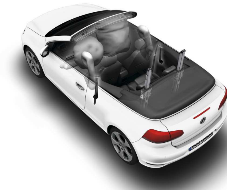
Obr. 17 Vysouvací rámy u vozidel bez střechy (VW)[40]
