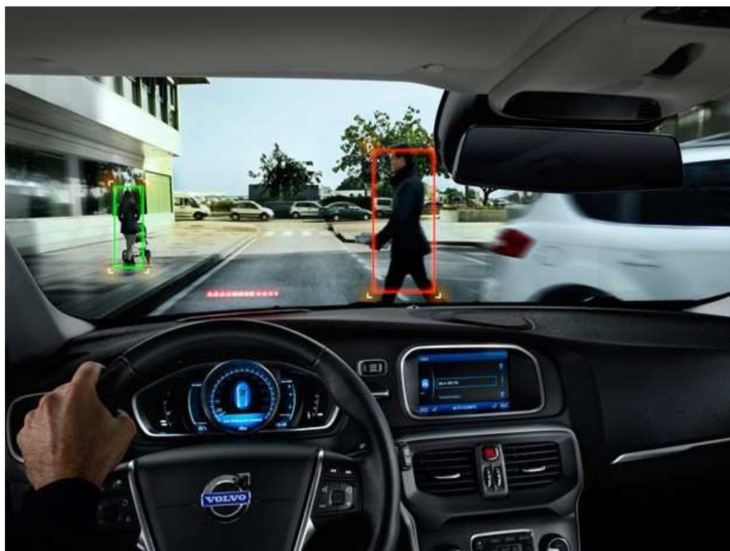
Obr. 9 Detekce chodců a varovné světlo v head-up displeji (Volvo)[20]
