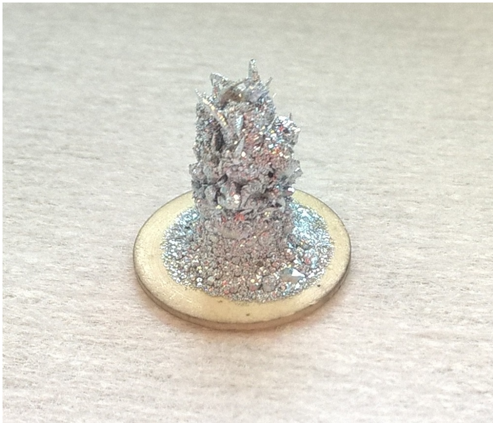
Obr. 5.7: Polykryštál zinku, ktorý sa vytvoril na uzávere kalíška a upchal ho.
