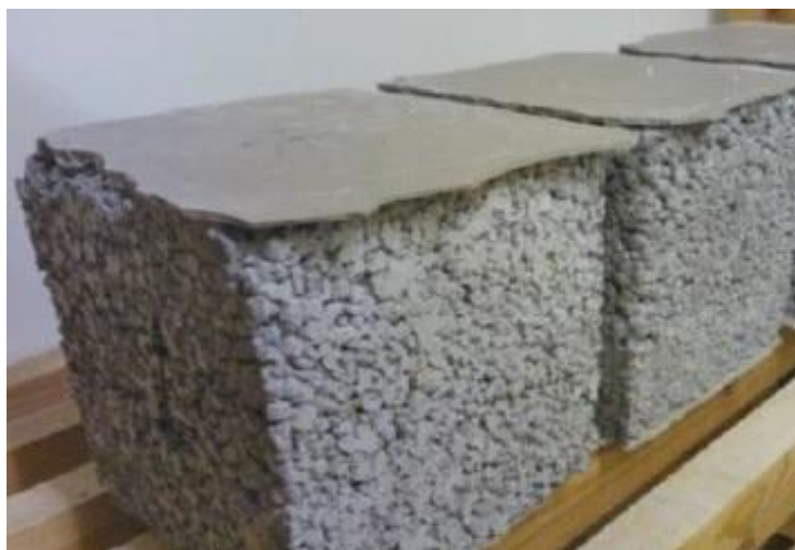
Obr. 3.1 Příklad usazení cementového mléka na dno formy při předávkování směsi vodou [O3]
