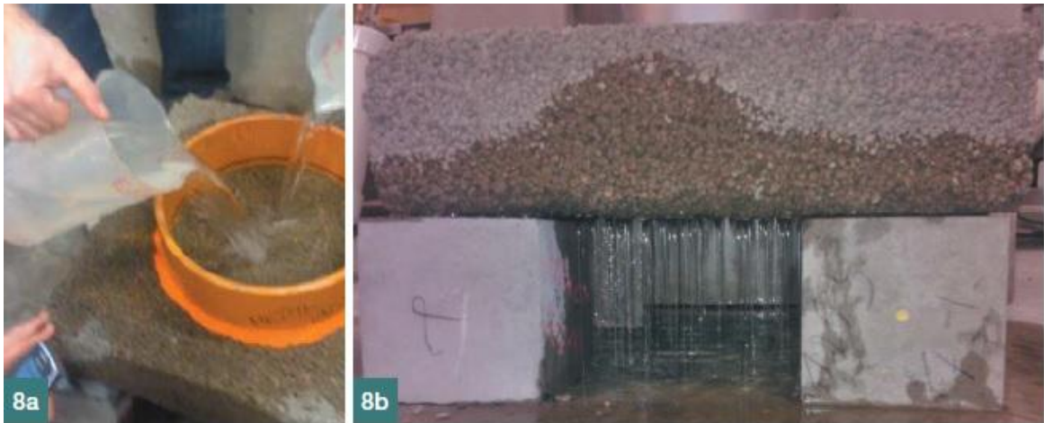
Obr. 7.1 Měření průsaku vody metodou prstenců [O4]
