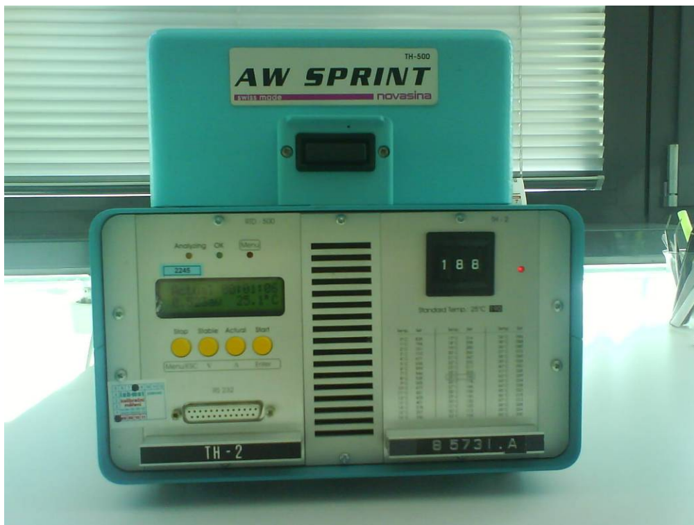
Obr. 8: Přístroj NOVASINA AW SPRINT pro stanovení aktivity vody.
