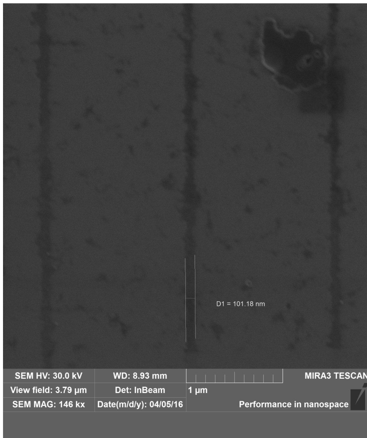
Obrázek 5.3: Fotografie grafenových proužků z SEM. Jsou pozorovatelné nečistoty a občasné přerušení proužků.
