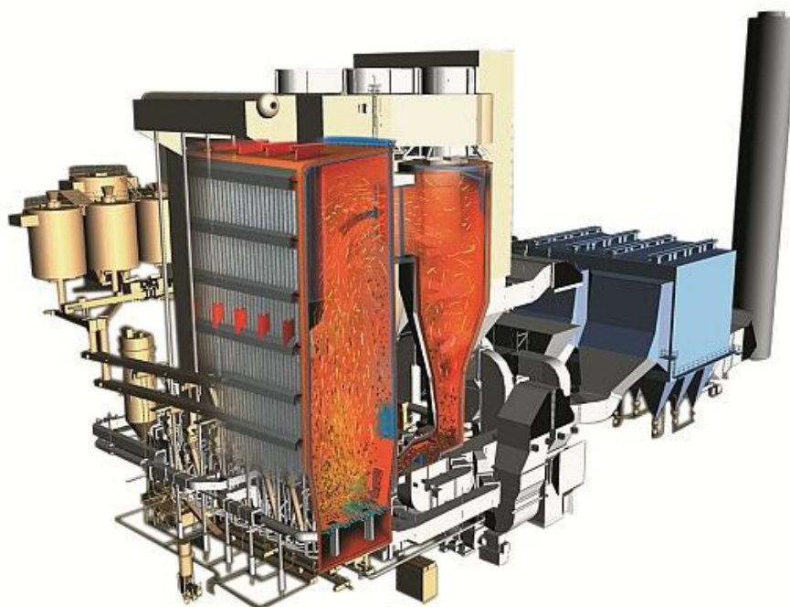
Obr. 14, Technologie odsiřování nového kotle K14 ostravské huti ArcelorMittal [27]
