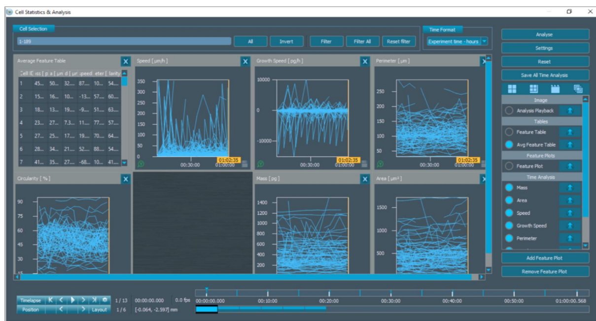
Obr. 2.6 Užívateľské prostredie softwaru Q-Phase. Okno nástroja analýza, v ktorom zobrazujeme tabuľku priemerných parametrov a časové grafy priebehu jednotlivých pozorovaných parametrov.
