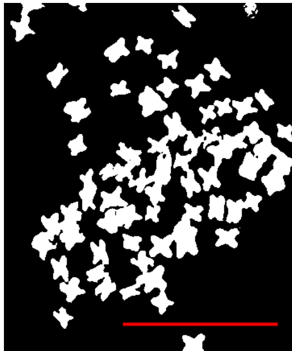
Obrázek 3.21: Segmentace PES vláken s algoritmem phase retrieval na základě histogramu. Délka červené úsečky je 100 \mu\text{m} .
